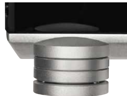
Nóżki są solidne i funkcjonalne; zamiast kolców niszczących parkiet, przygotowano „zawieszenie” na kulkach pomiędzy krążkami.
