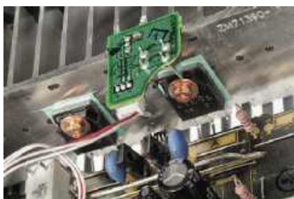
Końcówki mocy niewielkie, z parą tranzystorów Sanken, ale rozdzielone między radiatory niezależne dla każdego kanału.
