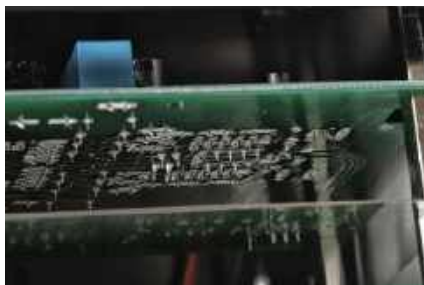
Wszeczhonna (MM/MC) sekcja gramofonowa zajmuje oddzielną płytke.
