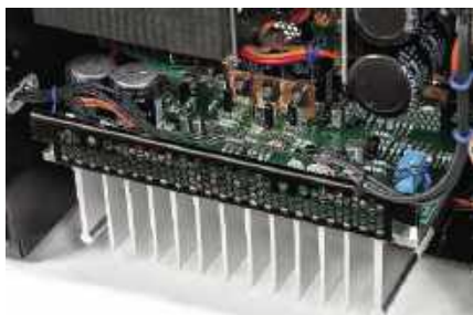
W końcówkach mocy pracują tranzystory bipolarnie (po 8 sztuk na stronę).
