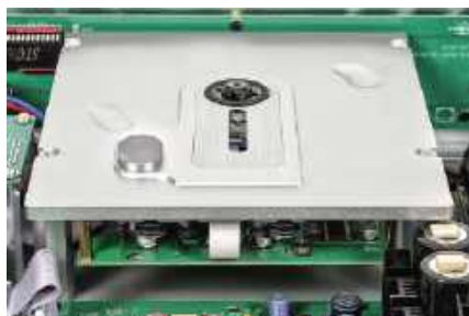
Mechanizm odczytujący płyty złożony jest z elementów Philips i Sanyo.
