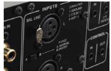
Jedno z wejść liniowych przygotowano na gnieździe XLR, chociaż to nie jest zbalansowane.
