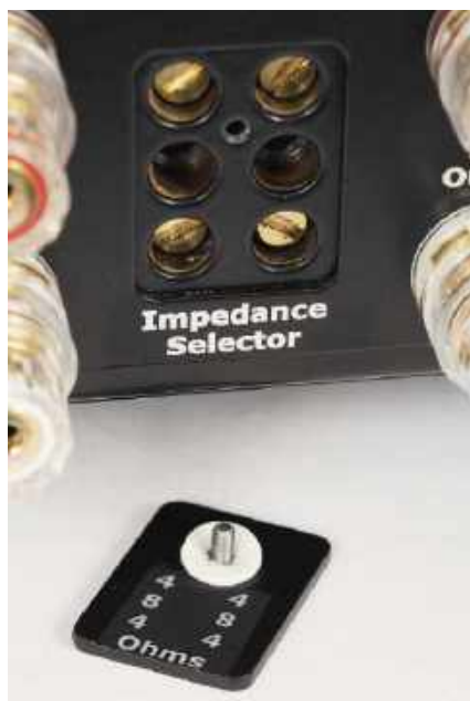
Przełącznik” odczepów transformatorów wyjściowych ma formę zestawu śrub, które należy wkręcić w odpowiednie gniazda. Na zdjęciu fabryczne ustawienie „4 Ω”.
