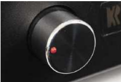
Analogowy potencjometr połączony jest z silniczkem, VA950 jest zdalnie sterowany.
