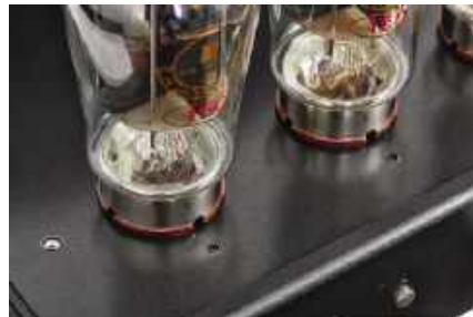
Każdej lampie KT150 towarzyszy kontrolna dioda sygnalizująca uszkodzenie.
