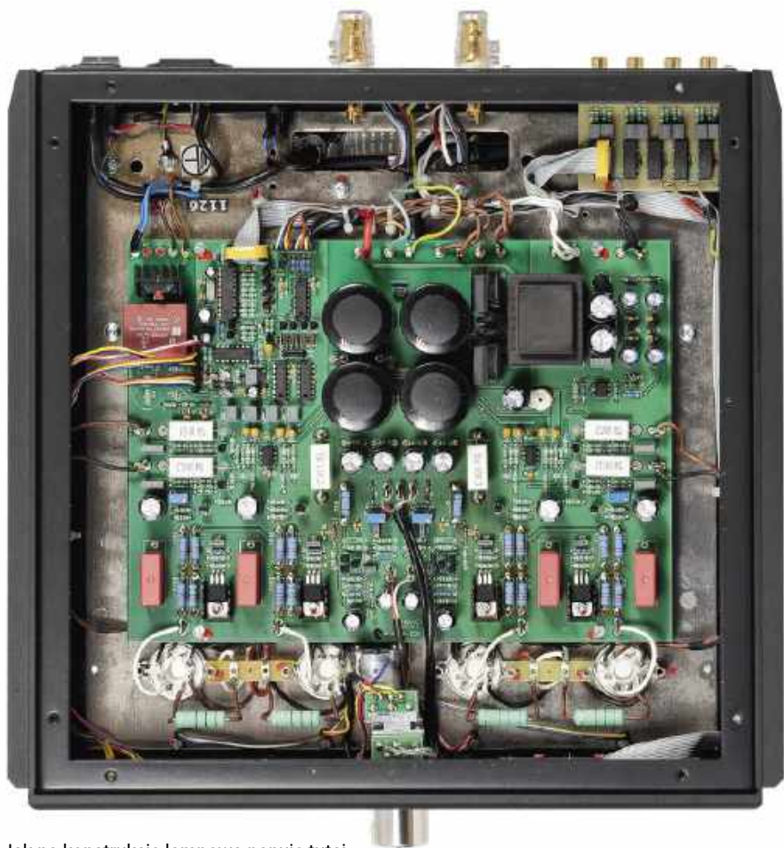
Jak na konstrukcję lampową panuje tutaj wyjątkowy porządek, większość elementów zmontowano na dużej płytce drukowanej.
