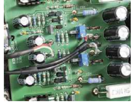
Połączenie tranzystorowego przedwzmacniacza z lampową końcówką mocy jest rozwiązaniem jeszcze bardziej niekonwencjonalnym niż typowa „hybryda”.
