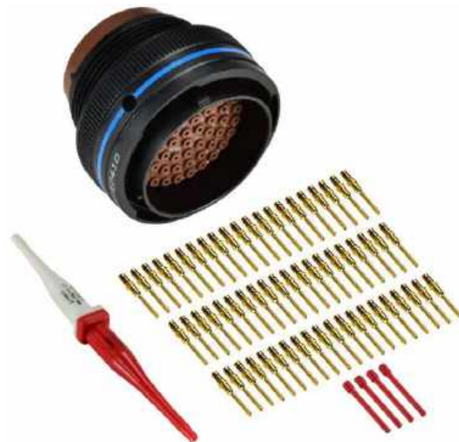
Fotografia 1. Złącze typu MIL-DTL-26482 produkcji Aero Electric ( https://www.prowireusa.com/ ) ma aluminiową, niklowaną obudowę i złocionymi pinami z fosfobrazu. Dostępna jest również wersja w obudowie z pokryciem kadmowym lub anodyzowana na czarno
