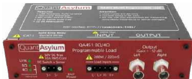
Fotografia 4. Programowalne obciążenie QA451 (fot. z materiałów QuantAsylum)
