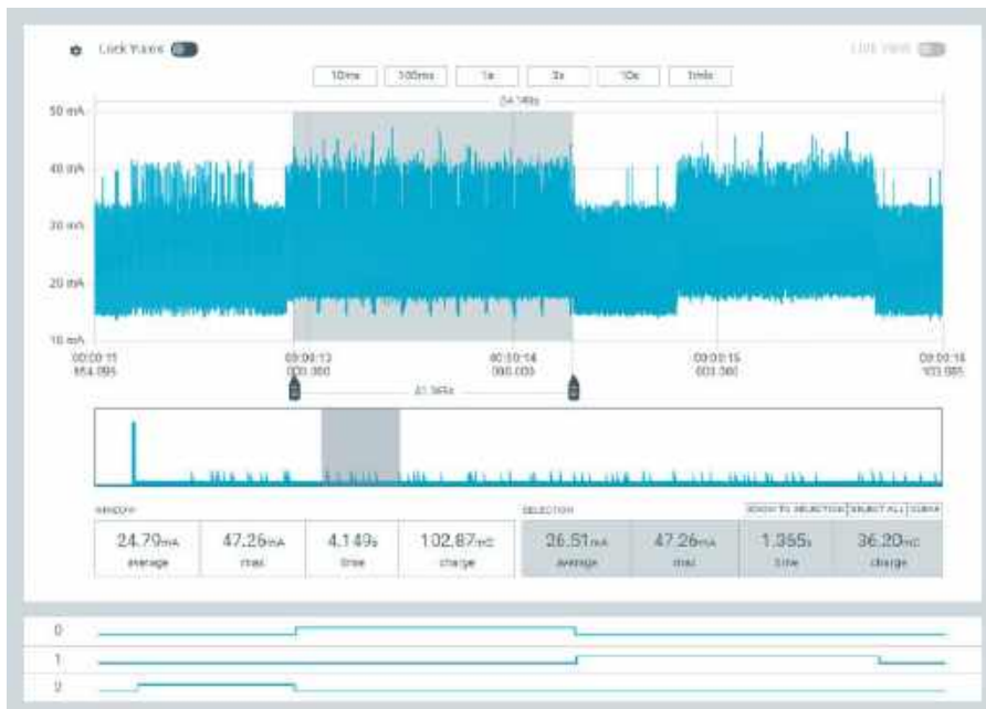
Rysunek 6. Prąd zasilania układu pomiarowego z sondą pH i wzmacniaczem
