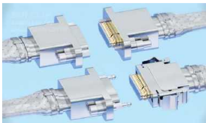
Fotografia 11. Złącza Micro-D firmy Axon, wyposażone w szybkozłącza z dodatkowymi zapięciami, zabezpieczające przed rozłączeniem na skutek wibracji. Widoczne są także metalowe peszle kablowe z (również metalowymi) spinkami, zabezpieczające przewody przed uszkodzeniem oraz EMI ( https://www.axon-cable.com/ )
