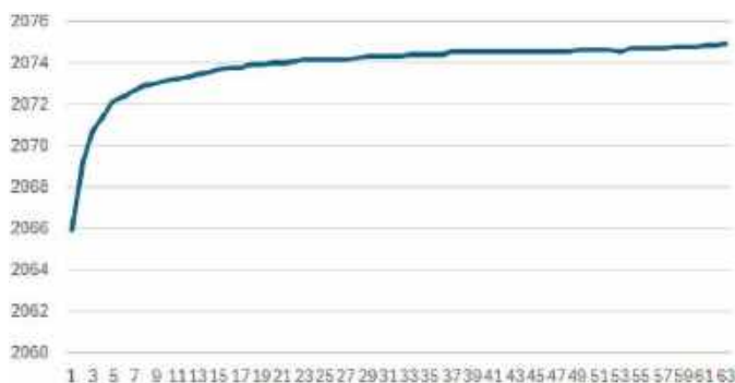
Rysunek 4. Napięcie sondy przy pH 4,0
