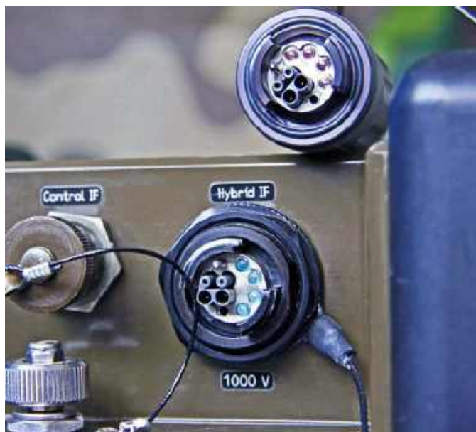
Fotografia 18. Złącze firmy Solifos integrujące w jednym konektorze połączenie elektryczne i optyczne ( https://solifos.com/ )
