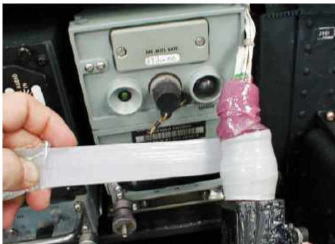
Fotografia 8. Izolująca, elastyczna taśma, służąca do owijania fragmentów złączy i połączeń we wiązkach kablowych ( https://www.avdec.com )
