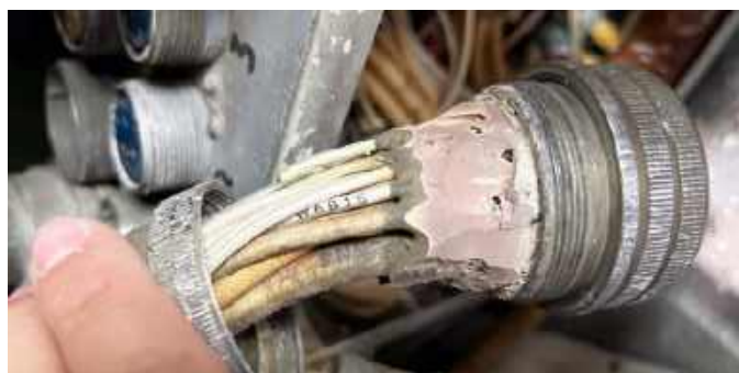
Fotografia 3. Okrągłe złącze wojskowe typu MIL-DTL-5015 zalane żywicą w tylnej części. (Źródło: strona użytkownika AlexDG1993 na portalu Reddit)
