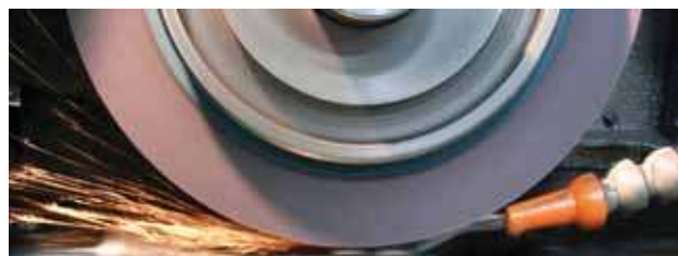
Foto 14. Generacja ciepła tarcia podczas szlifowania powierzchni obrabianego materiału, źródło: Wikipedia, Schleifen
