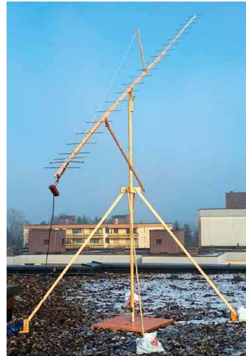
Rys. 6. 23-elementowa antena Yagi ma zysk 18,6 dB, co odpowiada antenie parabolicznej o średnicy 2,6 m przy sprawności 50%
