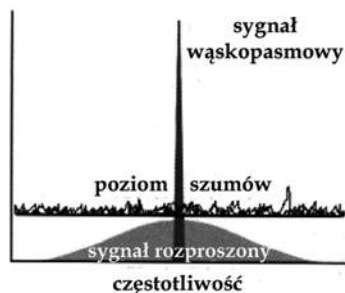
Rys. 1. Transmisja sygnału o rozproszonym widmie. Sygnał użytkowy jest rozpraszany po stronie nadawczej, a po stronie odbiorczej skupiany w identyczny sposób. Odbierane w tym samym paśmie sygnały wąskopasmowe ulegają rozproszeniu w odbiorniku i nie powodują zakłóceń
