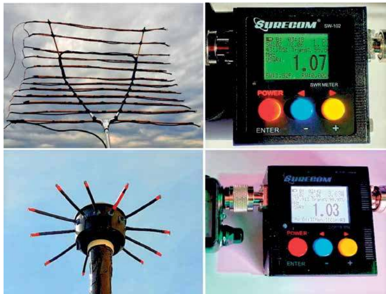
Konstrukcje antenowe Adama HF7ST i wyniki pomiarów
