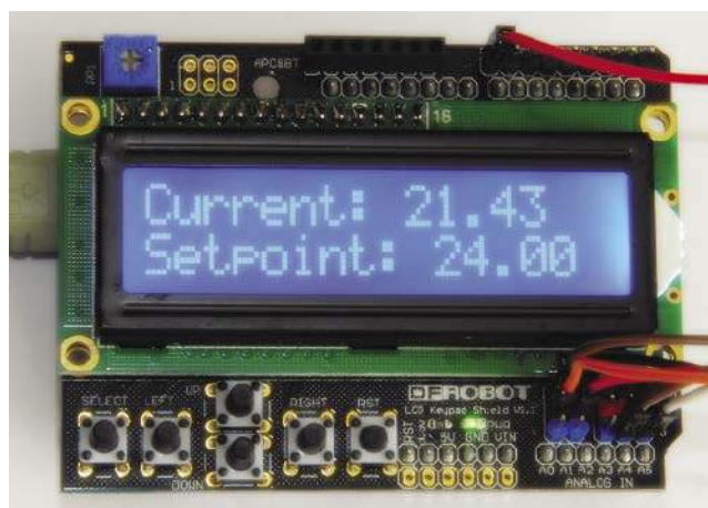
Rysunek 3. Moduł DFRobot 1602 LCD Keypad Shield podłączony do płytki Arduino Uno. Uno jest zaprogramowane oprogramowaniem XOD omówionym w tym artykule, a na wyświetlaczu widoczna jest aktualna temperatura oraz wartość zadana, przy której zapala się dioda alarmowa.
