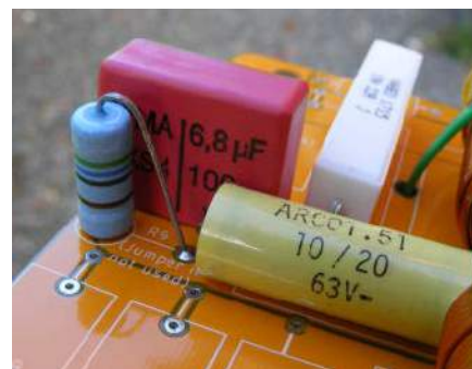
Rysunek 22. (powyżej po lewej) Rozkład komponentów dla zwrotnicy PE Mini-Monitor na płycie drukowanej uniwersalnej zwrotnicy pasywnej. (Uwaga: oznaczenie fazy głośnika wysokotonowego na płycie jest nieprawidłowe i powinno być odwrócone – tzn. na dole po prawej stronie zamienić '+' i '-' po obu stronach wyjścia 'HF'. (Jest to poprawne dla wersji LS3/5A, która ma odwrócone połączenie głośnika wysokotonowego, ale głośnik wysokotonowy dla PE Mini-Monitor jest podłączony w fazie). Zwróć też uwagę, że dwie centralne zwory („Link” na rysunku) trzeba przylutować do płytki. Rysunek 23a. (powyżej po prawej) pokazuje ukończoną zwrotnicę PE Mini-Monitor (uwzględnij połączenie drutem R3!). Rysunek 23b. (poniżej) Zwróć uwagę na pionowy montaż R9
