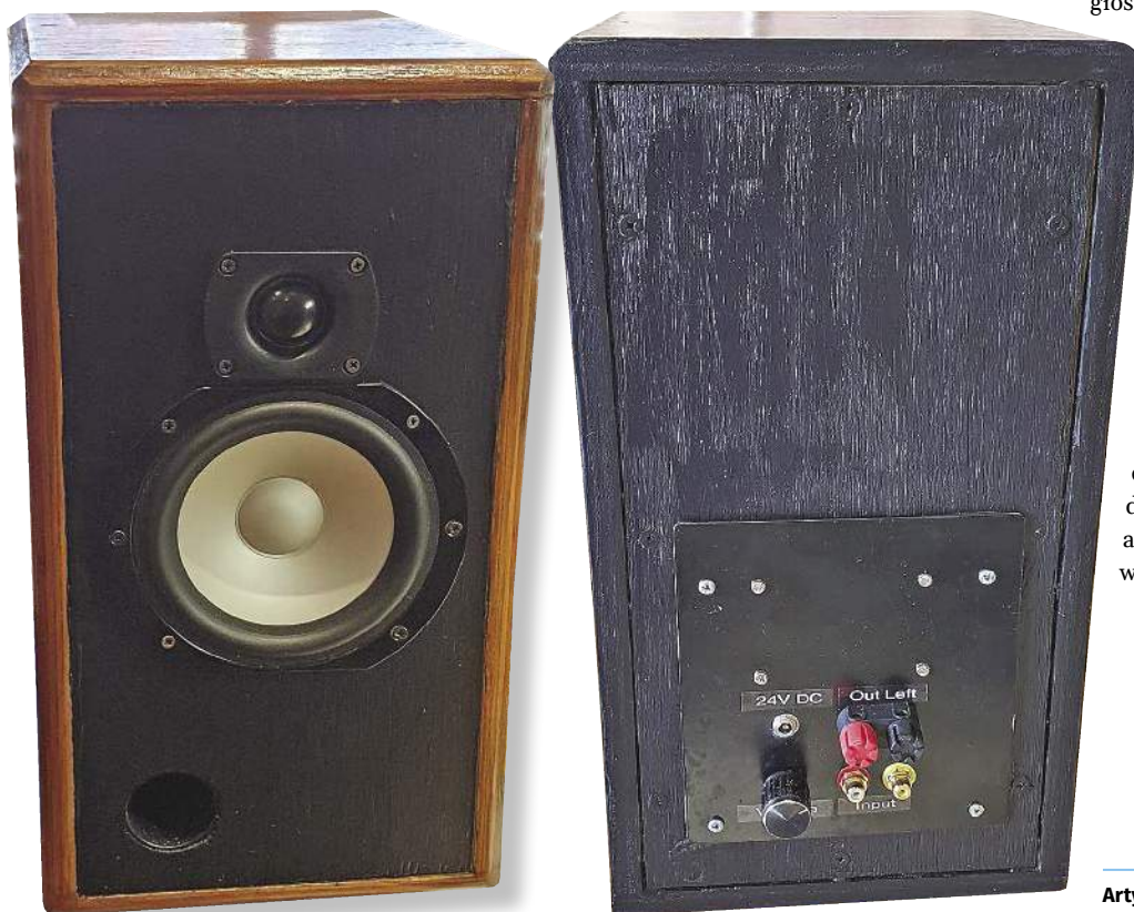
Przód i tył gotowych głośników. Ujęcie z tyłu to głośnik, w którym znajduje się wbudowany wzmacniacz audio.
