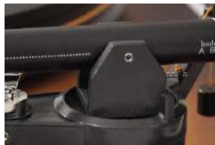
Regulację wysokości kolumny przeprowadzamy luzując śruby blokujące dolny pierścień.
