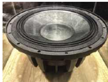
25-cm głośnik nisko-średnionowy, celuloza na tekstylnym zawieszaniu.
