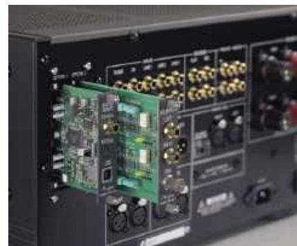
Karty rozszerzeń pozwolą podłączyć gramofon i źródła cyfrowe.
