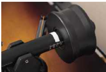
Do regulacji siły nacisku igły wykorzystujemy dużą przeciwwagę.
