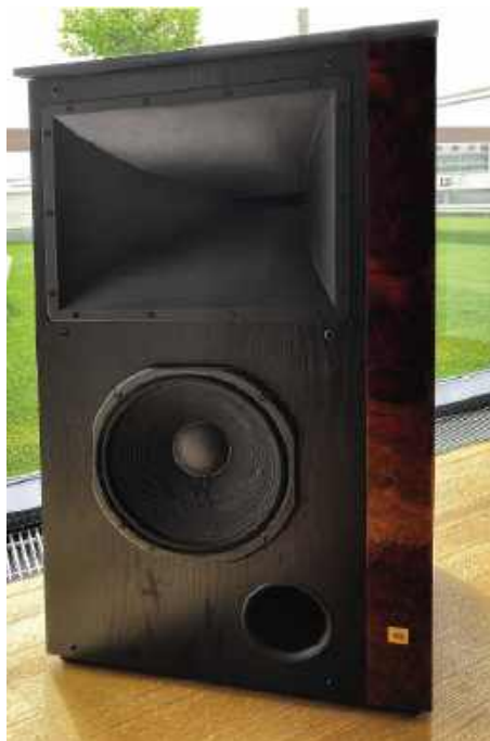
25-cm głośnik nisko-średnionowy, celuloza na tekstylnym zawieszaniu.
