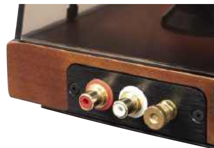
Sygnał z wkładki odbieramy przez gniazda RCA w tylnej części plinty.
