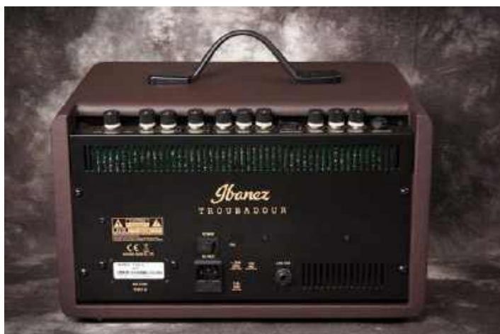
Na pokładzie mamy oddzielnie regulowane efekty chorus i pogłos dla kanału instrumentalnego, oraz pogłos dla kanału mikrofonowego.
