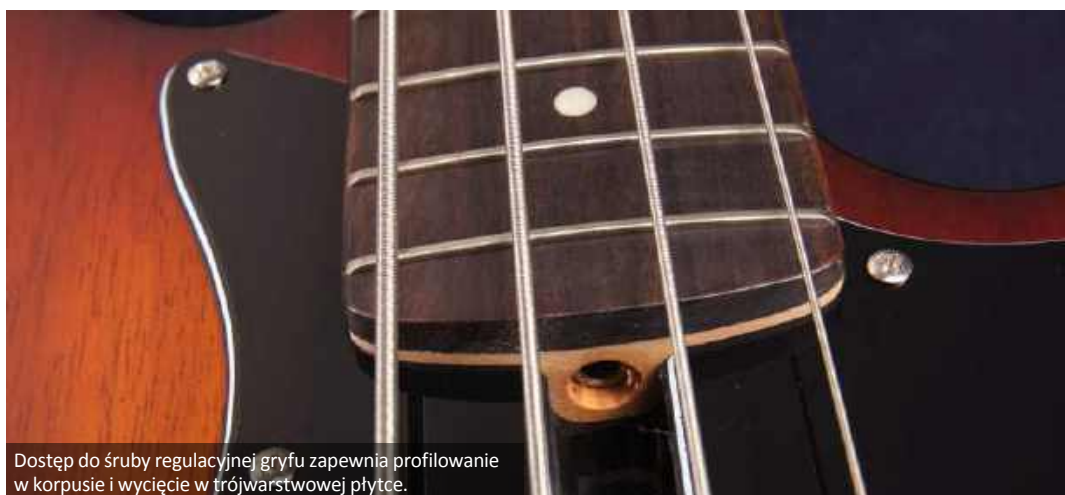
Mostek ze strunami przewlekkanymi przez korpus to konstrukcja typu vintage.
