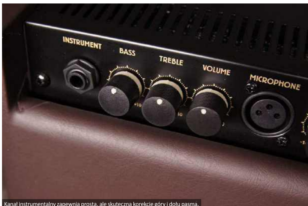
Kanał instrumentalny zapewnia prostą, ale skuteczną korekcję góry i dołu pasma.
