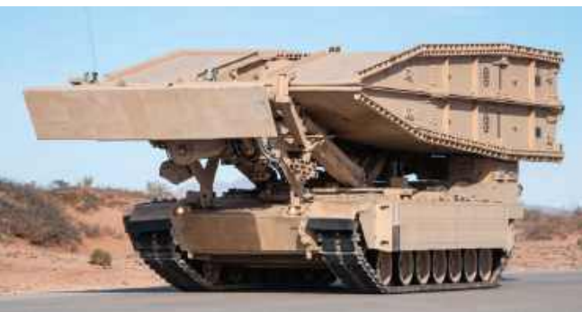
M1074 na podwoziu czołgu M1 to mobilny most, który zapewnia jednostkom pancernym zdolność przeprawy przez przeszkody, w tym rzeki.
