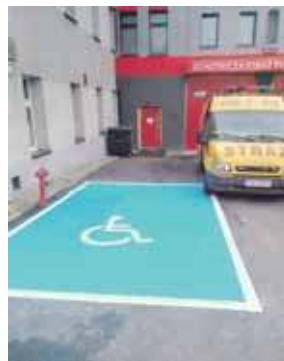
Miejsce jest niefortunnie usytuowane. Z jednej strony jest hydrant, z drugiej wyjazd straży pożarnej
