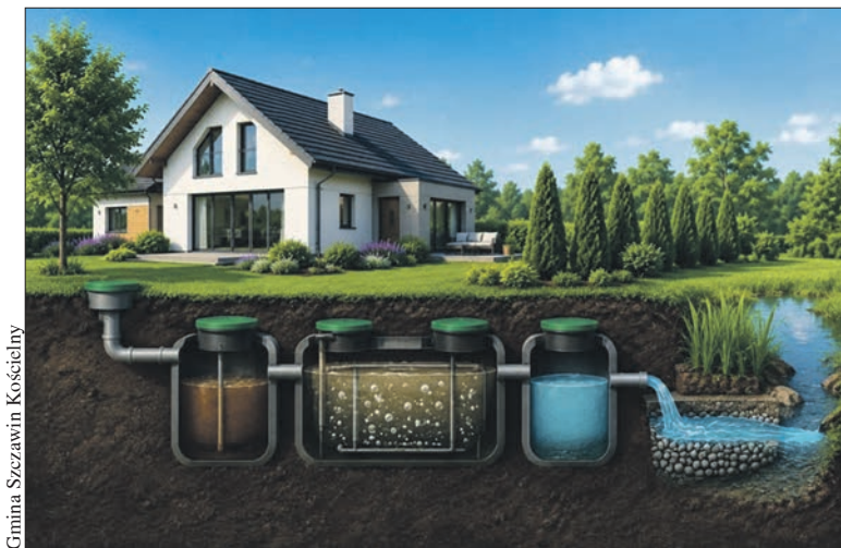
Wizualizacja przydomowej oczyszczalni ścieków
