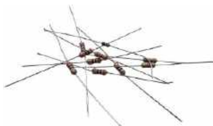
Fotografia 3. Stosik rezystorów wydzielonych spośród innych elementów dostępnych w zestawie. Które z nich na jakich lokalizacjach zamontować?
