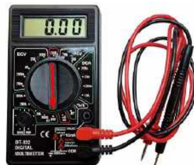
Rysunek 2. Multimetr z poprawnie podłączonymi przewodami (czerwony do złącza „VΩmA”, czarny do złącza „COM”) oraz ustawiony na funkcję pomiaru rezystancji, na najmniejszy możliwy zakres „do 200 Ω”)
