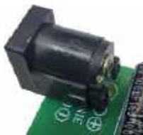
Fotografia 15. Typowe gniazdo zasilania 2.1/5.5 mm (barrel jack) zamontowane w otworach przewidzianych do prowadzenia kabli baterii 9 V
