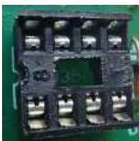
Fotografia 8. Podstawka powinna zostać zamontowana w kierunku zapewniającym zgodność wcięcia na białym opisie na płytce drukowanej i wcięcia na jednym z boków podstawki. Docelowo w tej podstawie zostanie osadzony układ scalony. Również w tym samym kierunku
