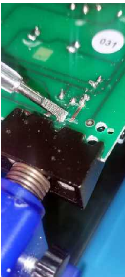
Fotografia 20. Kornel przeprowadza naprawę zerwanego połączenia pomiędzy ścieżką a padem lutowniczym jednego z komponentów. Na zdjęciu widać ścieżkę z usuniętą soldermaską, gotową do pocynowania i ponownego zespolenia z padem lutowniczym za pomocą cyny i srebrzanki lub odciętego po wcześniejszym przylutowaniu fragmentu wyprowadzenia innego komponentu
