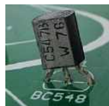
Fotografia 9. Prawidłowy montaż tranzystora T1 na płytce PCB
