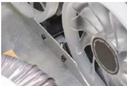
Wentylatory 120 mm dla wzmacniacza 500 W są mocowane do podstawy obudowy za pomocą metalowego wspornika. Są to wentylatory są dość powszechne w komputerach i można je nabyć za niewielką cenę. Można też użyć mniejszych wentylatorów (np. 80 mm), ale będą one prawdopodobnie głośniejsze i, ze względu na powszechność wentylatorów 120 mm, prawdopodobnie również droższe
