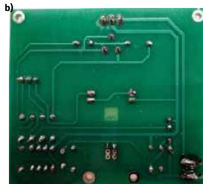
Fotografia 16. Poprawnie zmontowany zestaw Wściekły byk LED: a) widok od strony montażu komponentów, b) widok od strony lutowania
