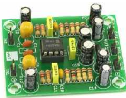
AVT1023 Przedwzmacniacz gramofonowy o charakterystyce RIAA https://sklep.avt.pl/avt1023.html
