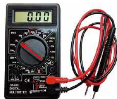
Rysunek 5. Multimetr z poprawnie podłączonymi sondami pomiarowymi, ustawiony na funkcję woltomierza napięć stałych (obszar DCV miernika) na zakres „do 20 V”
