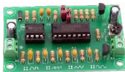
AVT1327 Mini generator funkcyjny https://sklep.avt.pl/avt1327.html
