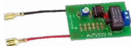
AVT1533 Zabezpieczenie akumulatora 12 V przed rozładowaniem https://sklep.avt.pl/avt1533.html
