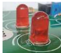
Fotografia 12. Widoczna z bliska większa elektroda we wnętrzu diody LED to zazwyczaj katoda, czyli elektroda ujemna diody LED. Przylutowana dioda zastąpiła znaczek „+” na opisie PCB, ale widać, że większa elektroda jest skierowana w stronę ścicia namalowanego na obwodzie okręgu symbolu diody LED, czyli do minusa
