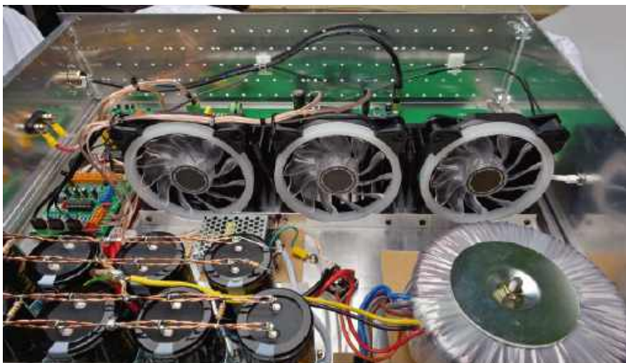
Wentylatory 120 mm dla wzmacniacza 500 W są mocowane do podstawy obudowy za pomocą metalowego wspornika. Są to wentylatory są dość powszechne w komputerach i można je nabyć za niewielką cenę. Można też użyć mniejszych wentylatorów (np. 80 mm), ale będą one prawdopodobnie głośniejsze i, ze względu na powszechność wentylatorów 120 mm, prawdopodobnie również droższe
