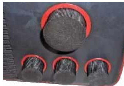
3. Wygląd zewnętrzny ścianki frontowej odbiornika radiowego ELTRA 820U JOWITA po zamontowaniu nowych pokręteł
