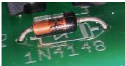
Fotografia 7. Poprawny montaż diody sygnałowej D1 na płytce PCB. Kierunek pasków na diodzie i nadrukowanym na płytce symbolu diody są zgodne
