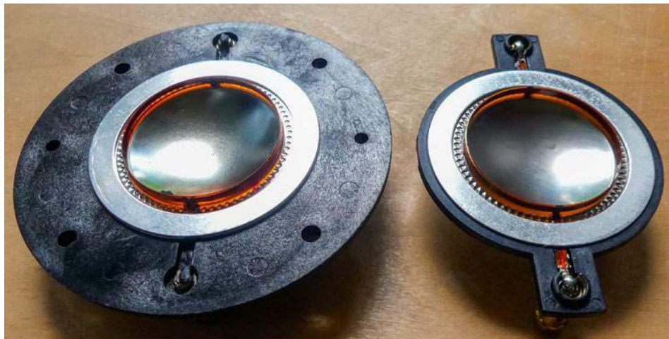
Membrana i zawieszenie w obu driverach są niemal identyczne.
