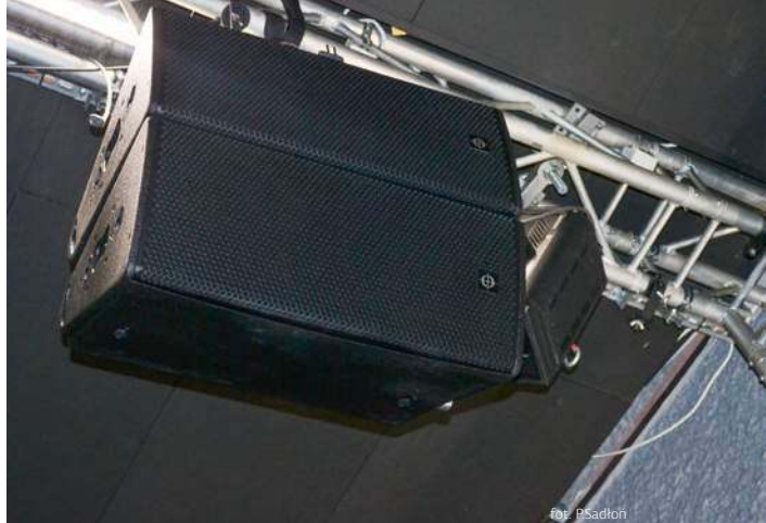
W gronie zastosowano zestawy APS o niesymetrycznie ukształtowanym rozproszeniu poziomym.
