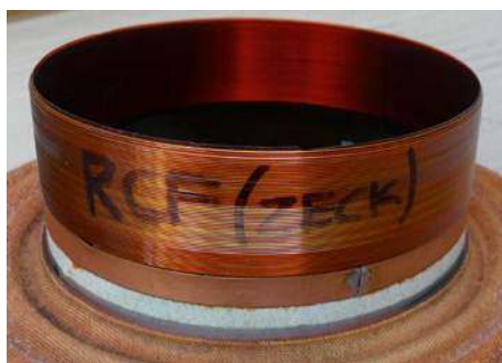
Cewka z głośnika 18" RCF po 20 latach nie wykazuje żadnych uszkodzeń.
