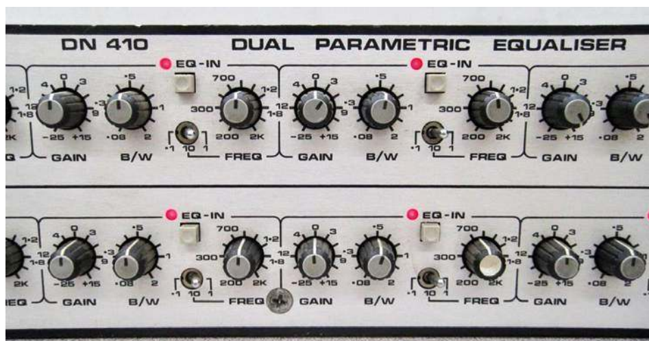
O wiele bardziej efektywnym narzędziem jest korektor parametryczny, wyposażony w zestaw niezależnych filtrów, o możliwej do przestrojenia częstotliwości środkowej, szerokości reagowania oraz poziomie tłumienia lub wzmocnienia.
