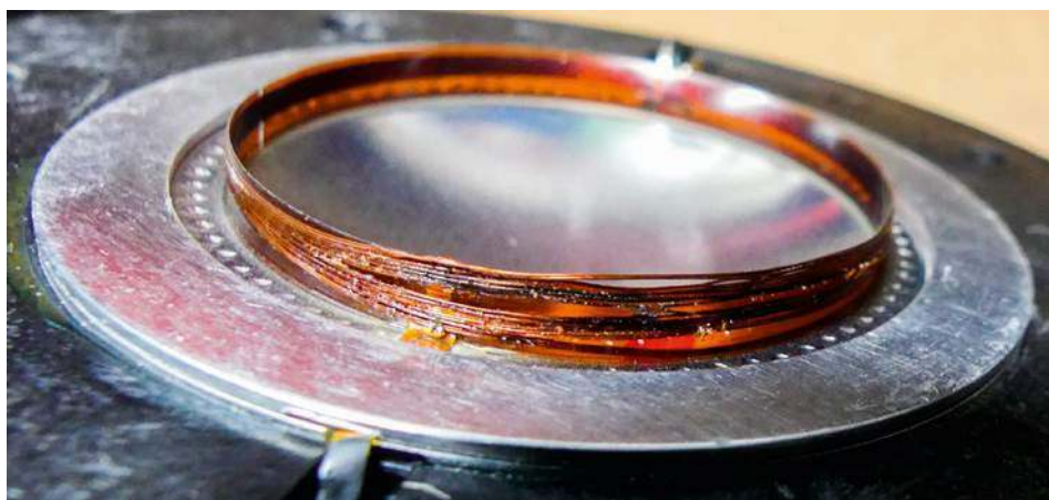
Uszkodzona cewka jednego z driverów.
