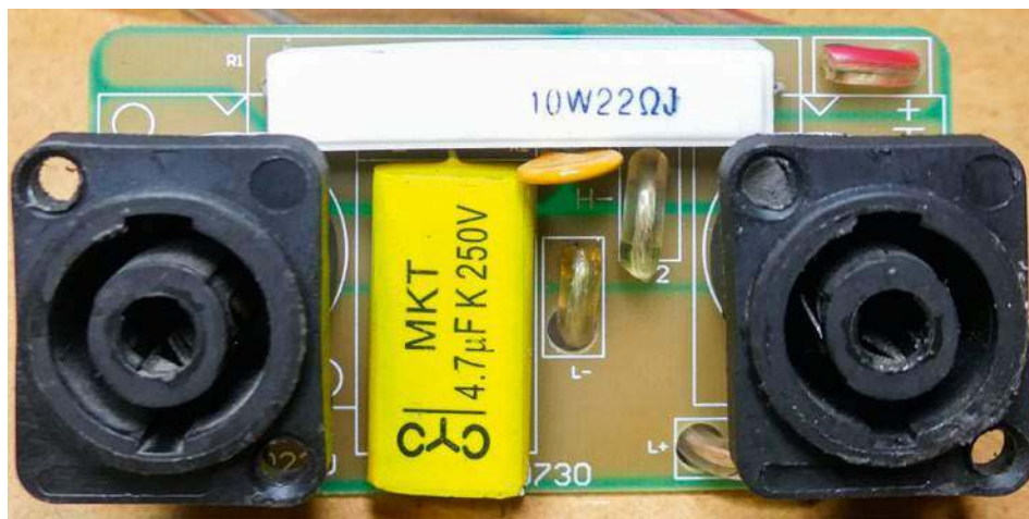
Filtr 6 dB blok dla drivera ciśnieniowego to nieporozumienie.
