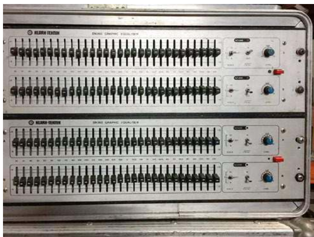
Klark Teknik DN360 wyposażony został w filtry o proporcjonalnej charakterystyce działania.
