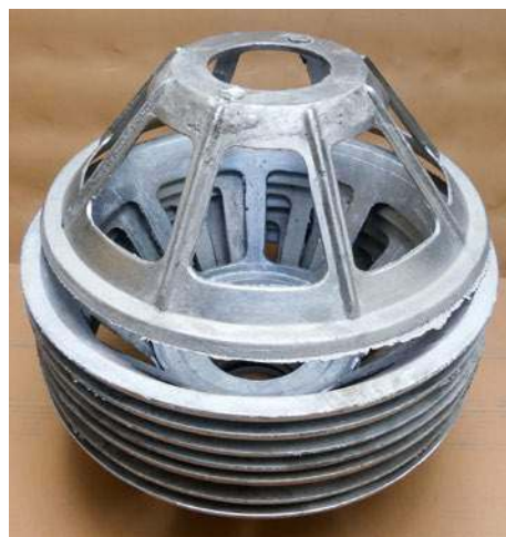
Kosze głośników PMP odlewane są metodą formowania w piasku.
