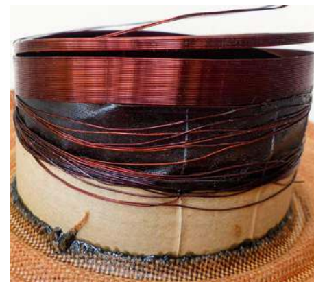
W obu głośnikach całkowitej destrukcji uległy cewki i ich karkasy.
