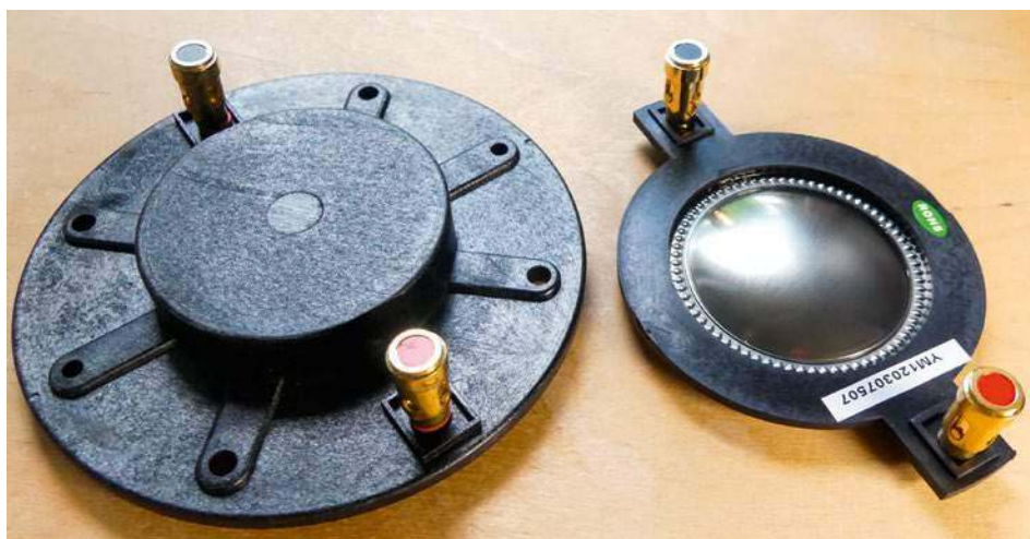
Drivery różnią się również sposobem wykonania zestawu naprawczego.
