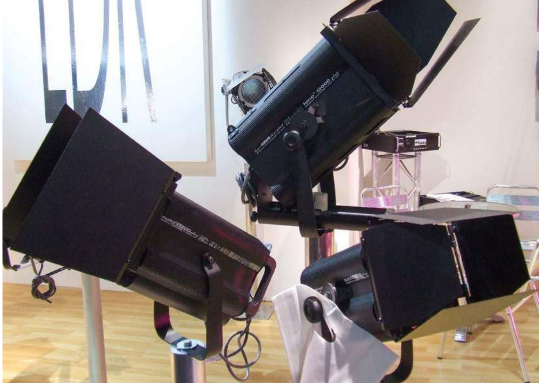
Konwencjonalne reflektory często wyposażane są w dodatkowe akcesoria, np. zewnętrzne skrzydełka, które pozwalają na kształtowanie wiązki światła.
