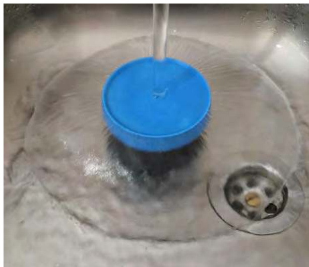
Fot. 3. Odskok hydrauliczny i rozprzysk wody na pokrywie pudełka od pasty do czyszczenia naczyń.
