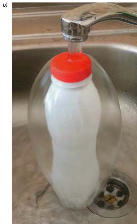
Fot. 7. Zakrzywienie dolnej powierzchni „parasola wodnego” w kierunku osiowym w zależności od prędkości wypływu: a) kształt zbliżony do powierzchni paraboloidy, b) kształt bardziej przypominający fragment powierzchni elipsoidy. Efekt uzyskano w wyniku rozplywu wody po odrzucie hydraulicznym na zakrętce plastikowej butelki od kefiru.
