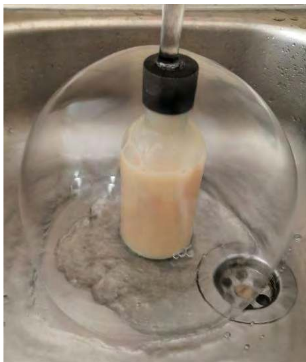
Fot. 2. Odskok hydrauliczny i rozplyw wody na zakrętce plastikowej butelki od szamponu.
