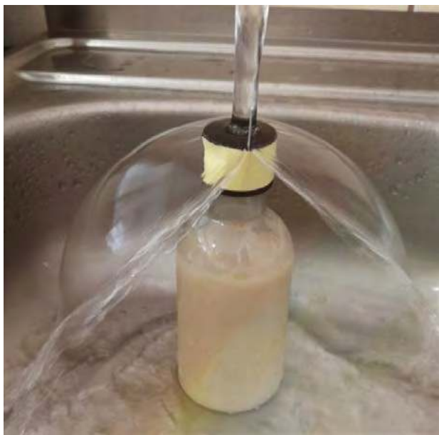
Fot. 5. „Namiocik wodny” spowodowany przez odskok hydrauliczny i rozpliw wody na zakrętce plastikowej butelki od szamponu z ogranicznikiem rozplywu wykonanym z kawalka drutu (fragment spinacza biurowego), przymocowanym taśmą klejącą do brzegu zakrętki.
