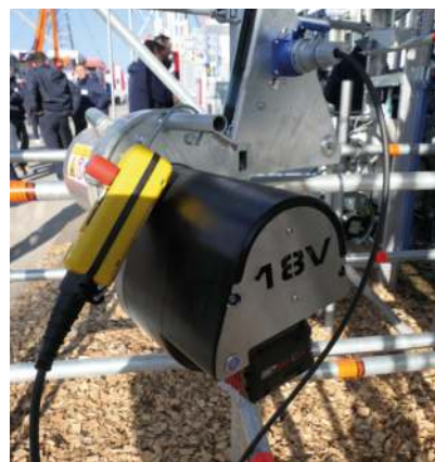
Fot. 3. Wciągarka linowa GEDA MAXI 18 V
