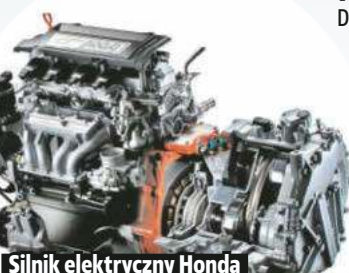
Silnik elektryczny Honda osadziła między jednostką spalinową a skrzynią biegów (tu bezstopniową).
