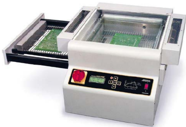
Fotografia 33. Komorowy piec konwekcyjny DDM Novastar GF-B ( https://t.ly/ljjw )
