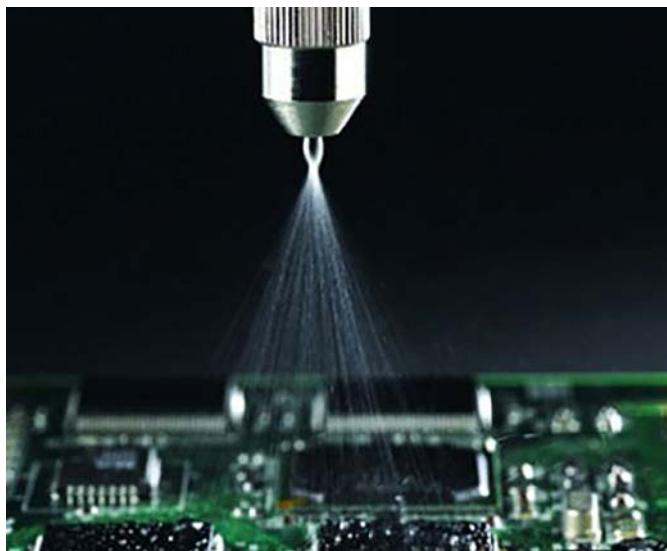
Fotografia 36. Natrysk ochronnej powłoki konformalnej ( https://t.ly/MjnS )
