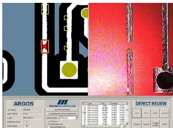
Rysunek 3. Przykład detekcji uszkodzenia PCB za pomocą systemu automatycznej inspekcji optycznej (AOI) – po prawej: oryginalna makrofotografia obwodu drukowanego, po lewej: obraz po przetworzeniu (progowanie, segmentacja, kolorowanie warstw) i oznaczeniu uszkodzenia ( https://t.ly/Us73 )
