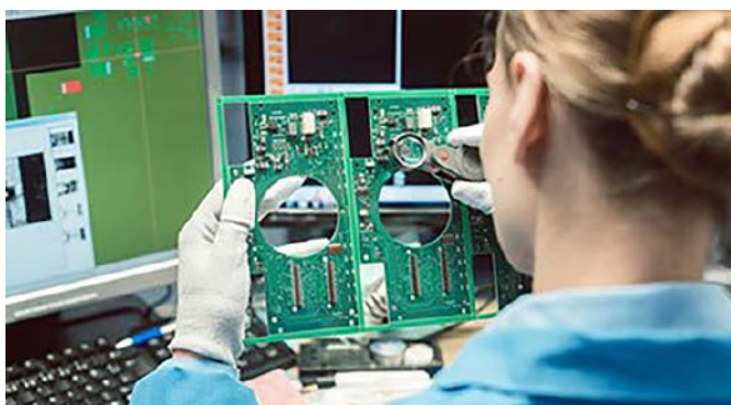
Fotografia 34. Wstępna inspekcja wzrokowa zmontowanych PCB ( https://t.ly/mYNX )
