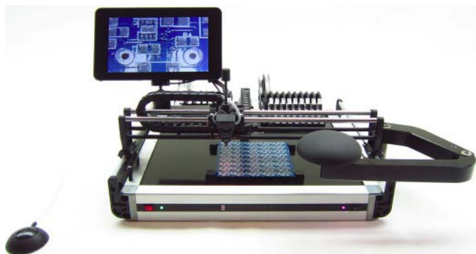
Fotografia 29. System wspomagania manualnego układania elementów SMD o nazwie SMT Caddy ( https://t.ly/n1CZ )
