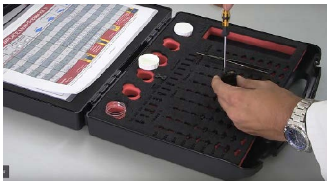
Fotografia 28. Zestaw do składania końcówki roboczej pick & place SIPLACE TwinStar ( https://t.ly/xCWG )
