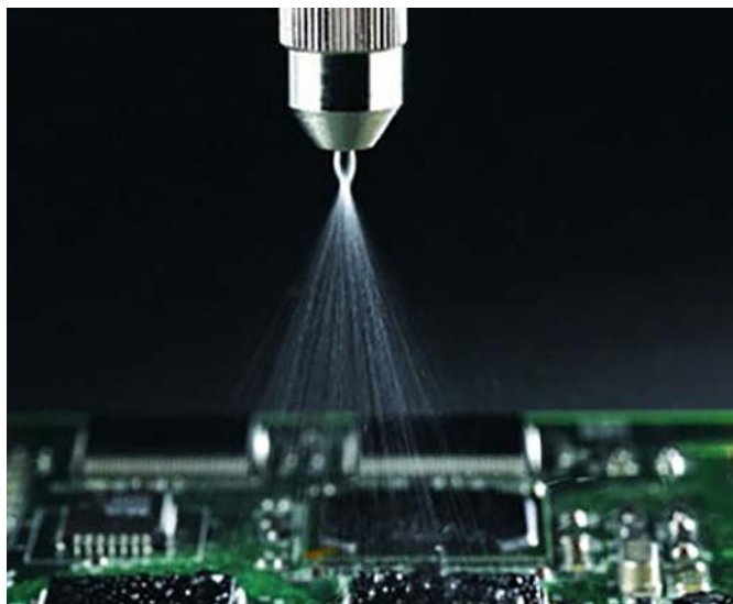
Fotografia 36. Natrysk ochronnej powłoki konformalnej ( https://t.ly/MjnS )
