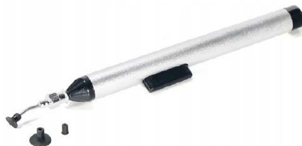
Fotografia 14. Najprostszy chwytak podciśnieniowy ( https://t.ly/XBih )
