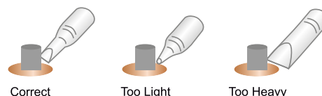
Rysunek 1. Schematyczne zobrazowanie metody doboru rozmiaru końcówki grota do wymiaru lutowanych elementów. Po lewej – grot optymalny do danego zastosowania; w środku – za mała końcówka, uniemożliwiająca przekazanie wystarczającej ilości ciepła; po prawej – za duży grot, uniemożliwiający dokładny montaż, w skrajnym przypadku grożący przegrzaniem przy nieprawidłowym ustawieniu temperatury stacji lutowniczej ( https://t.ly/zuFf )
