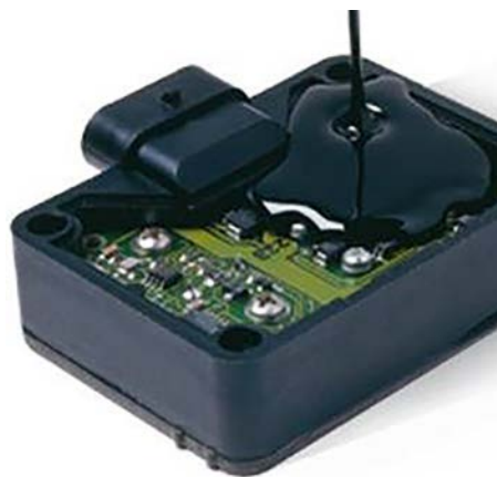
Fotografia 37. Zalewanie modułu żywicą ochronną ( https://t.ly/op73 )
