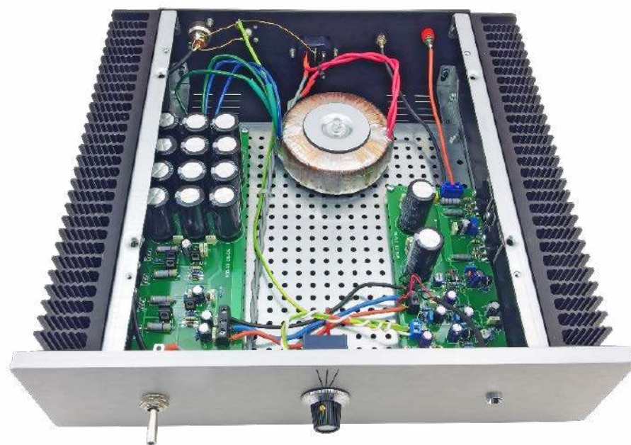
Fotografia 3. Wygląd wewnętrznej konstrukcji wzmacniacza
