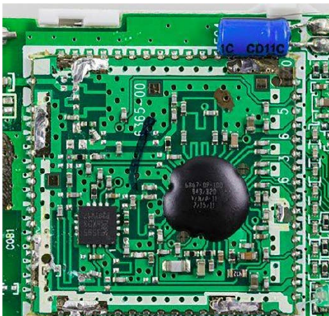
Fotografia 38. Przykładowy moduł wykonany przy użyciu technologii COB (chip-on-board) – widoczne czarne pokrycie żywiczne nad głównym układem scalonym ( https://t.ly/UQSN )
