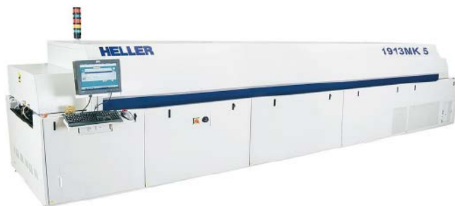
Fotografia 31. Wielostrefowy piec do lutowania rozpliwowego ( https://t.ly/RoLK )
