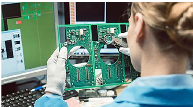
Fotografia 34. Wstępna inspekcja wzrokowa zmontowanych PCB ( https://t.ly/mYNX )
