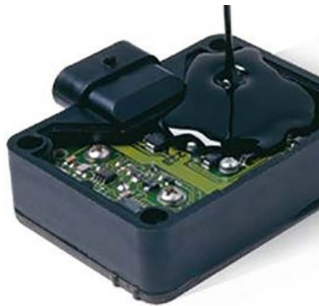
Fotografia 37. Zalewanie modułu żywicą ochronną ( https://t.ly/op73 )
