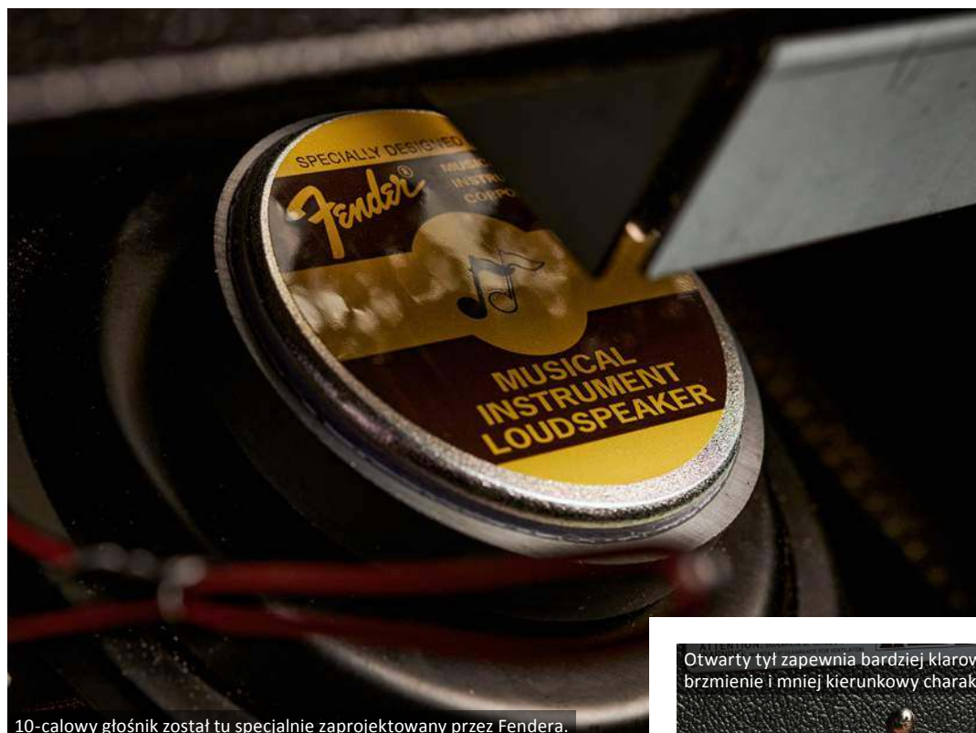
10-calowy głośnik został tu specjalnie zaprojektowany przez Fendera.
