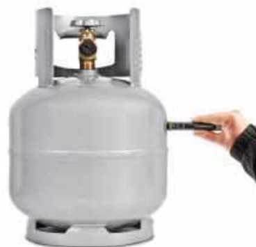
Ręczne pomiary ultradźwiękowym przyrządem można wykonać na butlach stalowych i aluminiowych. Taka metoda wymaga nieco wprawy
