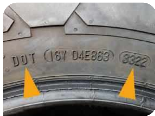
By faktycznie korzystać z uprawnienia „Tempo 100”, opony w przyczepie nie mogą być starsze niż 6-letnie. Ich rok produkcji uwidocznił się w formie czterocyfrowego kodu
