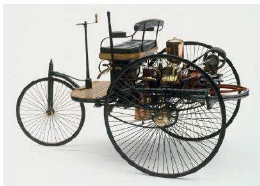
Patent-Motorwagen Nummer 1 Karla Benza – za siedzeniem widoczny mosiężny zbiornik na wodę, z którego spływała do płaszcza wodnego nalutowanego na cylinder
