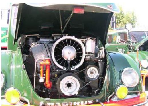
Cieżarówka Magirus Deutz 6500 z silnikiem wysokopiętnym chłodzonym powietrzem, rok budowy 1954
