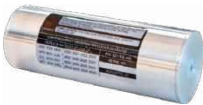
Rysunek 27. Pinger lokalizacji awaryjnej 8,8 kHz z baterią wystarczającą na 300 dni. Sygnały mogą być odbierane przez system CUUWi i pomagać w lokalizowaniu czarnych skrzynek samolotów, łodzi podwodnych w niebezpieczeństwie itp.
