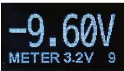
Zrzut ekranu 14. Stan początkowy pęsety: tryb miernika o zakresie do 30 V przy polaryzacji zarówno ujemnej, jak i dodatniej (między CON+ a CON-). Rozdzielczość przy napięciu do 9,99 V wynosi 10 mV, a powyżej tego napięcia 0,1 V
