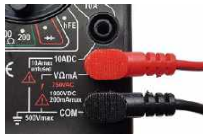
Fotografia 19. Poprawne podłączenie kabli na przykładzie multimetru DT-830B, ustawionego na funkcję woltomierza napięć stałych
