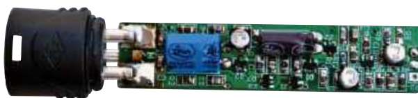
Wersje SMD (po lewej) i przewlekana (poniżej) skalibrowanego mikrofonu pomiarowego pokazane w powiększeniu. Oba mają zamontowane gniazda XLR
