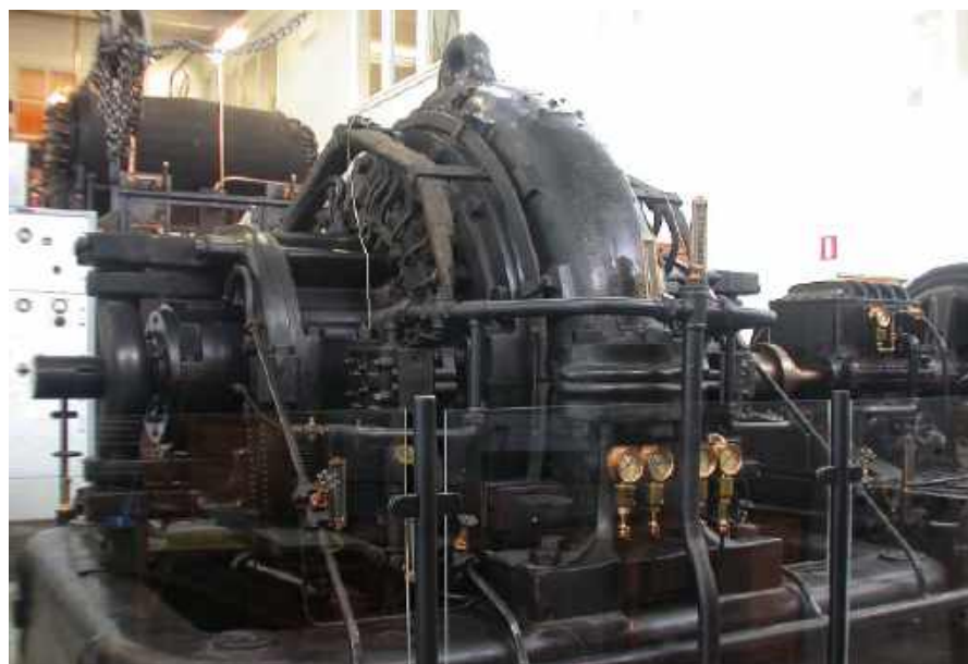
Rysunek 6. Alternator Alexanderson w stacji radiowej Grimeton. Źródło: https://w.wiki/6DPN
