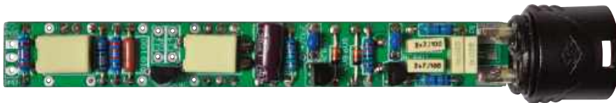
Wersje SMD (po lewej) i przewlekana (poniżej) skalibrowanego mikrofonu pomiarowego pokazane w powiększeniu. Oba mają zamontowane gniazda XLR
