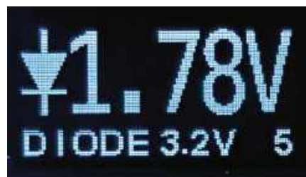
Zrzut ekranu 24. W trybie pomiaru diody wyświetlacz jest podobny jak w trybie automatycznym, ale prąd testowy płynie tylko w jednym kierunku: od CON+ do CON-. Umożliwia to szybkie wykrywanie polaryzacji i ogólne sprawdzanie diod LED
