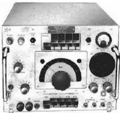
Rysunek 20. Odbiornik CFA, typ 5820-AP 164474, używany na okrętach podwodnych klasy Oberon. Źródło: http://jproc.ca/r/rp2/oberon_cfa.pdf
