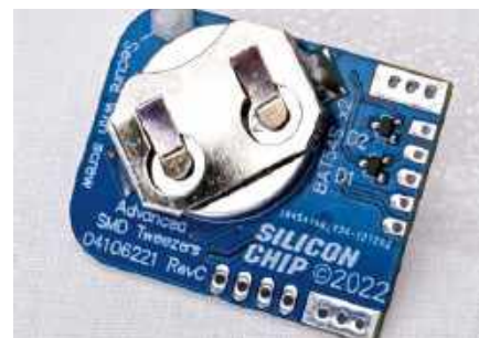
Wyjęcie baterii przez dziecko jest utrudnione przez nylonową śrubkę i dwie nakrętki
