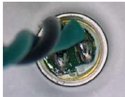
Zbliżenie na wewnętrzne okablowanie mikrofonu
