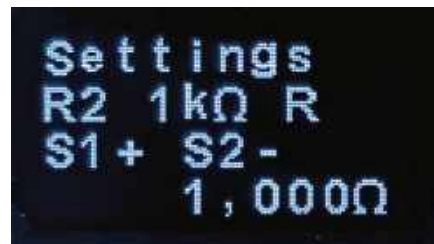
Zrzut ekranu 2. Wyniki w pęsecie będą dość dokładne również bez kalibracji. Lepiej jednak ją przeprowadzić, wpisując na kolejnych stronach zmierzone multimetrem dokładne wartości sześciu najbardziej krytycznych rezystorów (rysunek 5)
