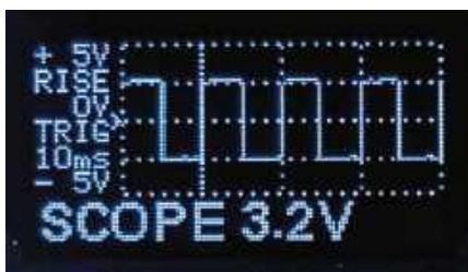
Zrzut ekranu 15. Bardzo przydatny jest tryb oscyloskopu, mimo że wykres sygnału ma tylko 100 pikseli w poziomie i 48 pikseli w pionie. Próbkowanie odbywa się z częstotliwością do 25 kHz, co jest wystarczające dla przebiegów o pasmie akustycznym. Jest kilka trybów wyzwalania
