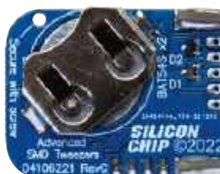
Spód pęsety (rozmiar rzeczywisty) jest prawie pusty; zawiera tylko gniazdo baterii i dwie diody
