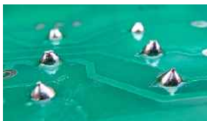
Fotografia 5. Po przylutowaniu komponentów przewlekanych do płytki nadmiar wyprowadzeń został obcięty pewnym ruchem ściskającym, bez szarpania i ciągnięcia, dzięki czemu połączenia pól lutowniczych z płytką i biegnące po niej ścieżkami pozostały nienaruszone
