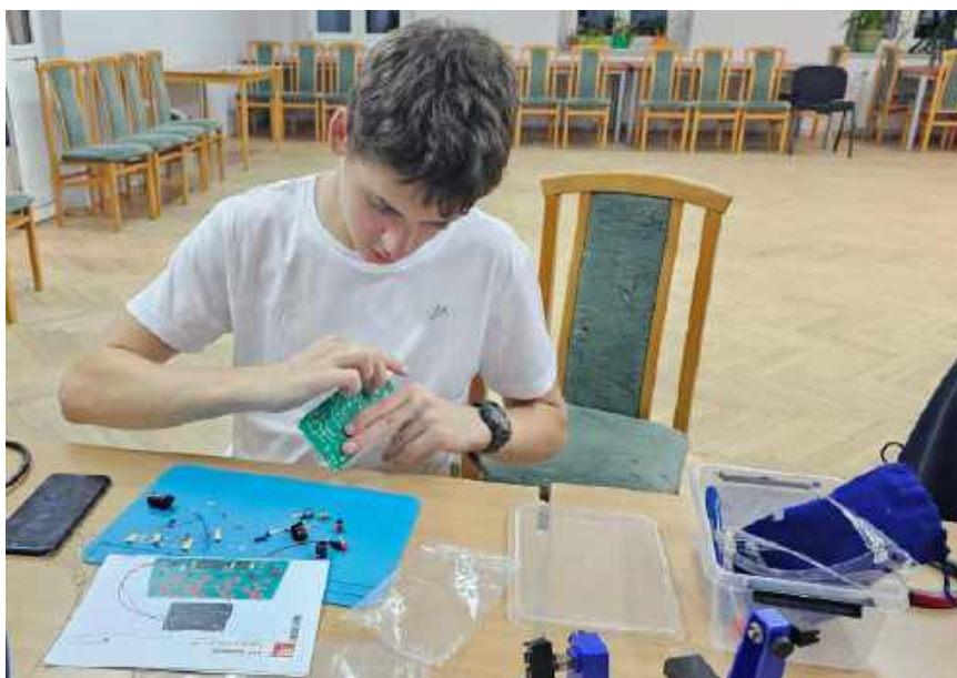
Fotografia 3. Podczas montażu rezystorów do PCB Kornel weryfikuje ich kody paskowe. Młodzi Entuzjaści Elektroniki, Szkoła Podstawowa nr 86, Wrocław
