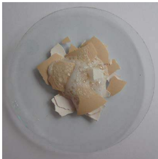
5. Skorupki jajka pienią się po polaniu roztworem kwasu, co świadczy, że w ich skład wchodzi węglan wapnia
