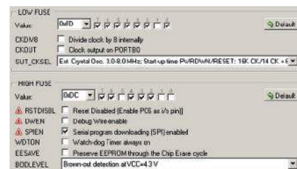
Rysunek 3. Szczegóły ustawienia bitów zabezpieczających
