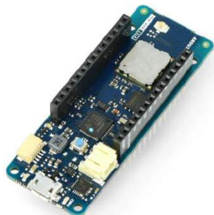
Fotografia 4. Moduł Arduino MKR WAN 1310 do realizacji komunikacji LoRa/LoRaWAN
