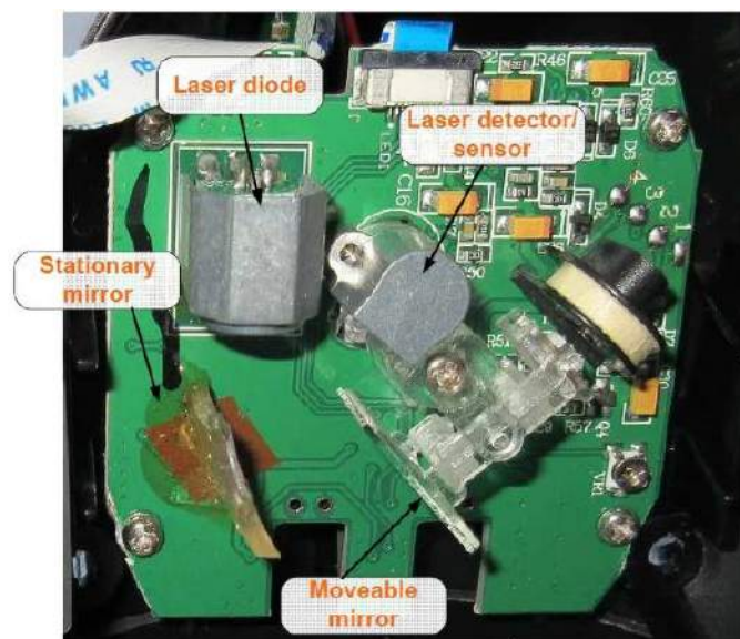
Fotografia 16. Układ mechaniczno-optyczny skanera laserowego z drgającym zwierciadłem na przegubie obrotowym ( https://bit.ly/3AiWjxF )
