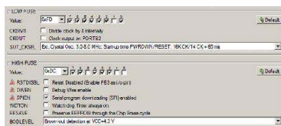
Rysunek 4. Szczegóły ustawienia bitów zabezpieczających
