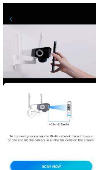
Rysunek 2. Produkcenci kamer IP korzystają z kodów wyświetlanych na ekranie aplikacji mobilnej w celu ułatwienia użytkownikom łączenia urządzeń z siecią WLAN ( https://t.ly/vGhK )
