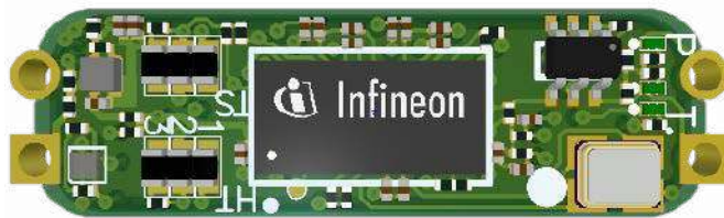
Rysunek 2. Płytkę prototypowego czujnika ruchu z detektorem BGT60LTR11AIP
