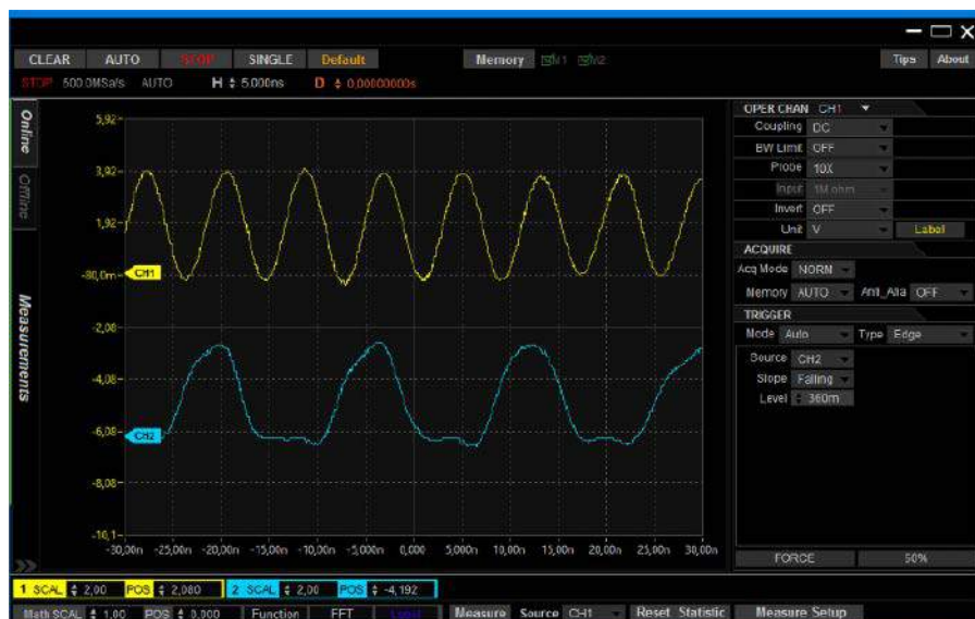
Rysunek 12. Oscylogram podczas pomiaru częstotliwości 120 MHz, którego efektem było niewłaściwe wskazanie
