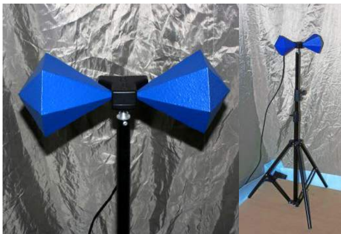
Fotografia 1. Detektor jest jednym z dwóch głównych elementów systemu do pomiaru EMI
