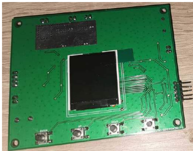
Fotografia 2. Strona BOTTOM zmontowanej płytki PCB
