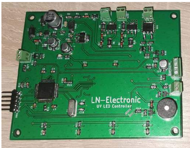
Fotografia 1. Strona TOP zmontowanej płytki PCB
