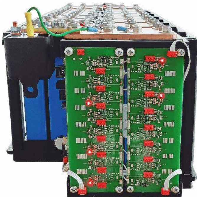
Fotografia 1. Układ BDMS zamontowany do akumulatora
