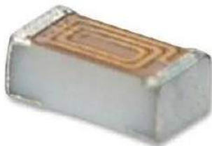
Fotografia 7. Subminiaturowy dławik cienkowarstwowy w rozmiarze 0201
