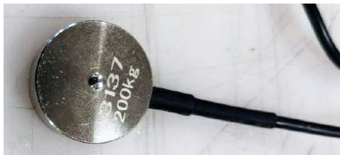
Fotografia 2. Zastosowany sensor tensometryczny
