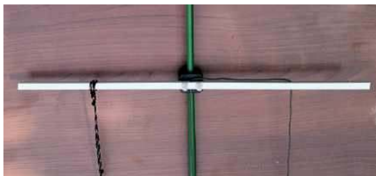
Rys. 11. Widok zmontowanego układu dopasowującego, zawierającego unun 4:1 i balun 1:1
