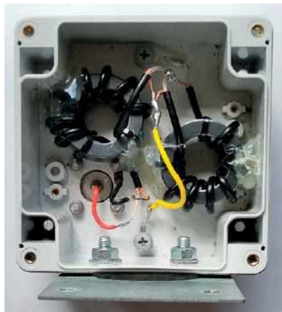
Rys. 11. Widok zmontowanego układu dopasowującego, zawierającego unun 4:1 i balun 1:1
