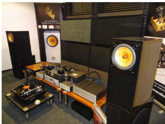
System głośnikowy Nenuphar; polska firma Cube Audio specjalizuje się w przetwornikach szerokopasmowych o wysokiej efektywności, więc towarzystwo wzmacniaczy lampowych wydaje się najodpowiedniejsze – w centrum grecki Tsakiridis Theseus.
