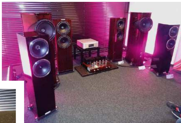
Największa z trzech kolumn na tym zdjęciu to Fyne F1-12, a nowsze od niej są F703 (w głębi, najbliższe wzmacniacza), i najmniejsze (najbliżej) F502 SP. Wszystkie mają koncentryczny moduł przetworników nisko-średnio-tonowych.
