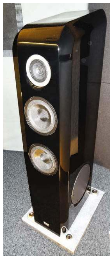
Evolution One E1 TX – kolumny TAD w nowym stylu (do posłuchania w Audio Stylu). Duże „talerze” na bocznych ściankach to dyfuzory otworów bas-refleks (głośniki niskotonowe klasycznie na froncie, towarzyszy im koncentryczny układ średnio-wysokotonowy z berylową kopułką).
