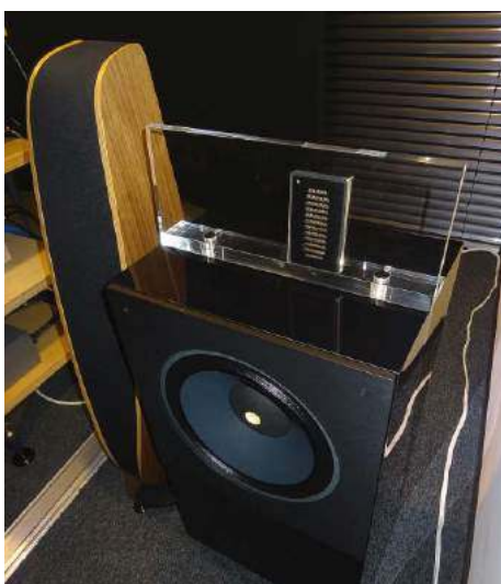
Nowe głośniki w ofercie Galerii Audio – Wolf von Langa; najmniejszy model Son, nisko-średnio-tonowy z elektromagnesem i wysokotonowy typu AMT. Obok Davone Twist.
