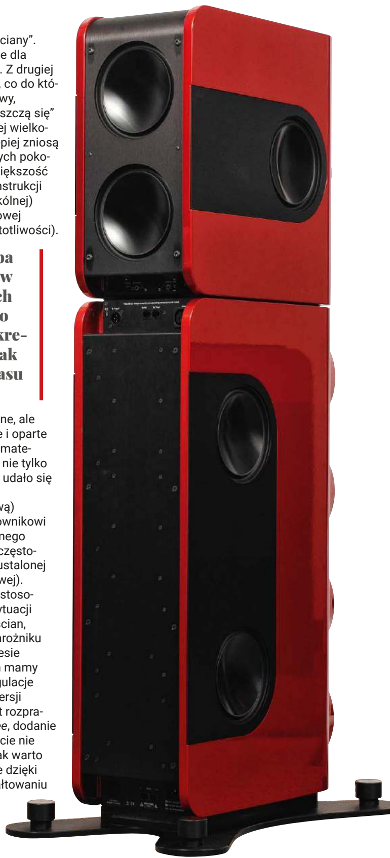
W dolnym module głośniki znajdują się z przodu i z boku, a w górnym – z tyłu i z boku. „Dolne przednie” mają charakterystyki (amplitudowe i fazowe) podobne jak „górne boczne”, a „dolne boczne” – zbieżne z „górnymi tylnymi”.
