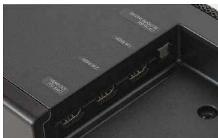
Panel przyłączeniowy koncentruje się na złączach HDMI, dwóch wejściach i jednym wyjściu (z eARC).
