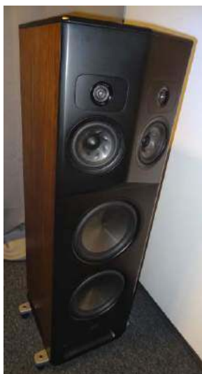
Również nowiutka i tym razem zaskakująca kolumna Polk Audio – L800 – nawiązuje do modelu SDA-SRS z 1985 roku. Zdublowane sekcje średnio-wysokotonowe nie służą powiększeniu obszaru odsłuchu, ale „doprecyzowaniu” stereofonii za pomocą wprowadzenia odpowiednich relacji fazowych. Taki system jest cechą tylko tej największej konstrukcji serii, ale do obydwu modeli wolnostojących (również do L600) można dodać (położyć na górze) moduł „atmosowy” L900.
