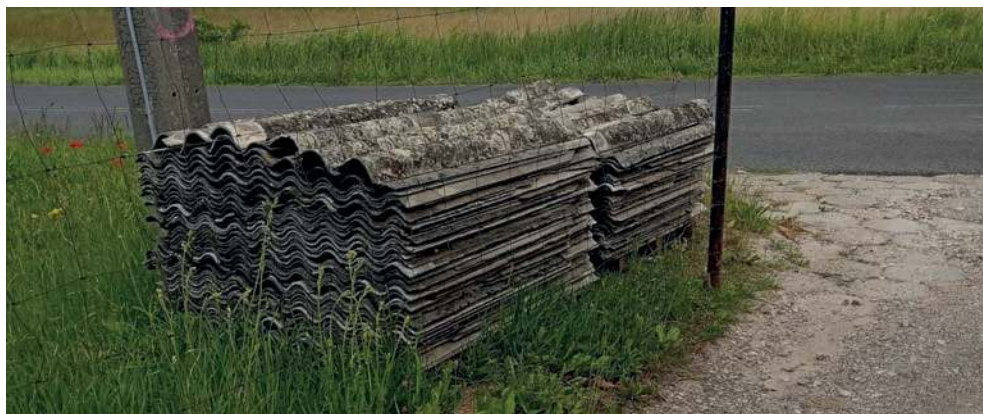
Płyty eternitowe przy ul. Obłazki w Nieporazie
