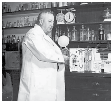
Dr Rolla Harger prezentuje "Drunkometr", pierw- szy praktyczny aparat służący do określania po- ziomu alkoholu we krwi poprzez analizę oddechu.
