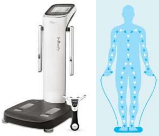
Rysunek 3. Urządzenie pomiarowe – waga oraz schemat przepływu impulsu elektrycznego o bardzo niskim natężeniu przez nogi, brzuch i ręce Źródło: https://www.inbody.com/global/product/body-composition-analyzer.aspx
