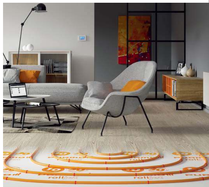
➊ Rury wodnego ogrzewania podłogowego układu się w odstępach co 10–20 cm, tworząc pętle z jednego odcinka, bez połączeń. PURMO
