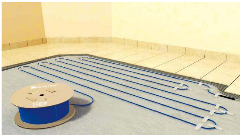
🔥 Przewody grzejne układają się w pętle, z zachowaniem 5–15 cm odległości między równoległymi odcinkami, i mocuje do podłoża taśmą montażową. ELEKTRA
