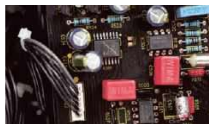
Regulator głośności to scalak Burr Browna z serii PGA.
