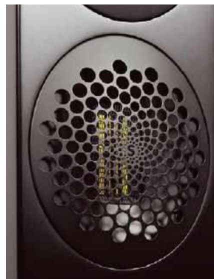
Ekstrawaganckie osłony głośników (na wszystkich takie same) okazują się też starannie zaprojektowane pod kątem akustycznym. Ich minimalny wpływ widać (w pomiarach) tylko w zakresie wysokich częstotliwości.
