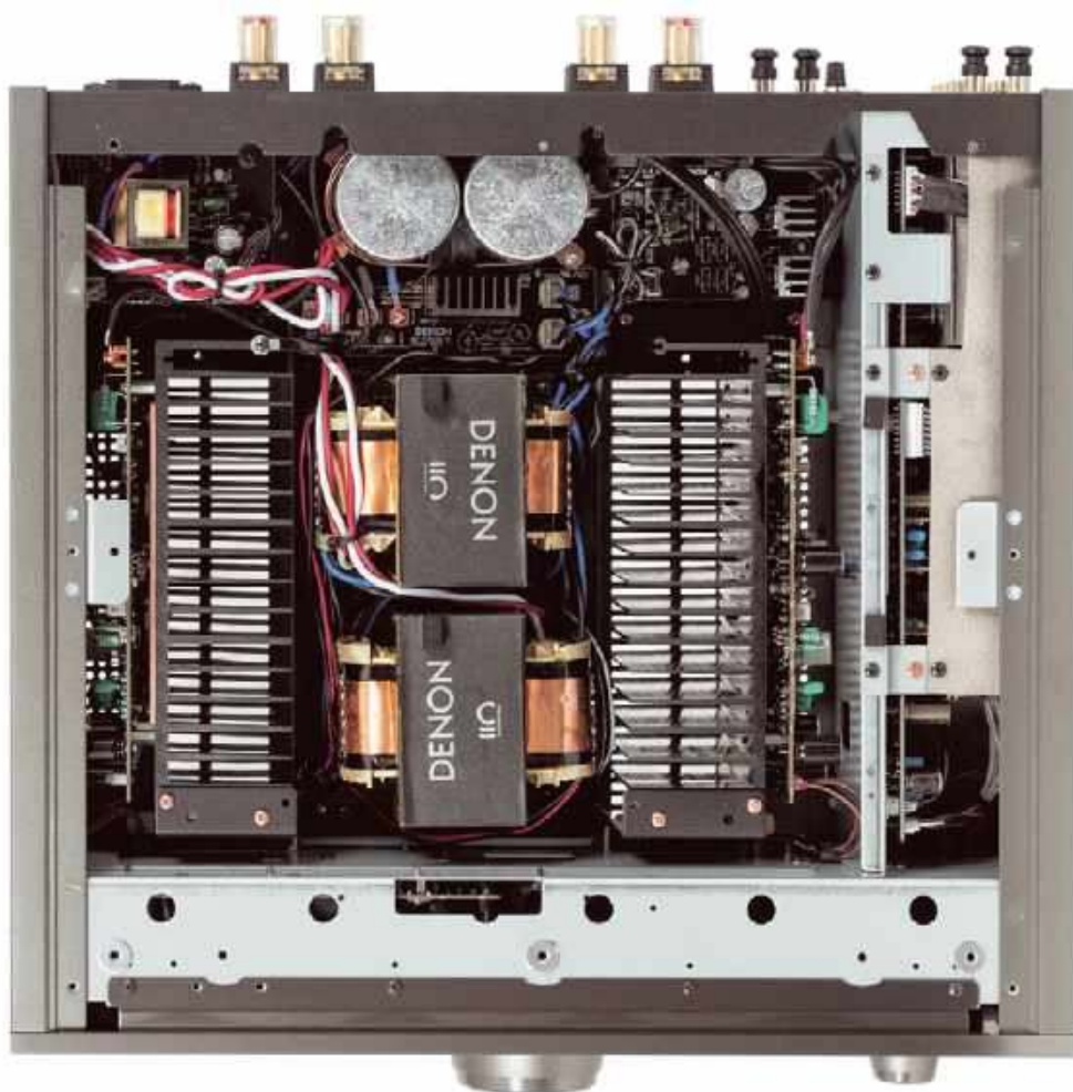
PMA-A110 to bezkompromisowy układ dual mono, uwagę zwracają też liczne ekrany separujące delikatne sygnały przedwzmacniacza.
