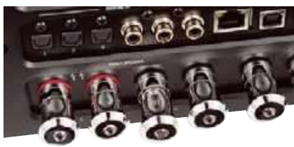
Terminale głośnikowe są podwójne i bardzo wygodne, choć trzeba uważać na dość nietypowy układ trzpień + i -.
