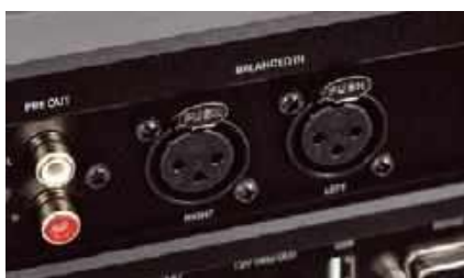
Do dyspozycji mamy wejście XLR, ale X3 nie jest konstrukcją zbalansowaną.
