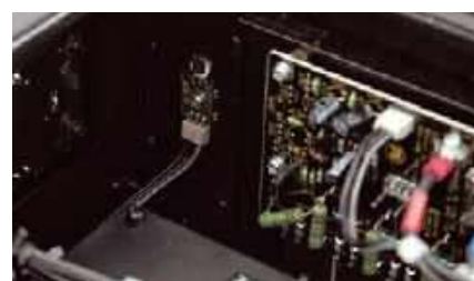
Nad bezpieczeństwem końcówek czuwa kilka obwodów, jeden z nich monitoruje temperaturę na radiatorach.
