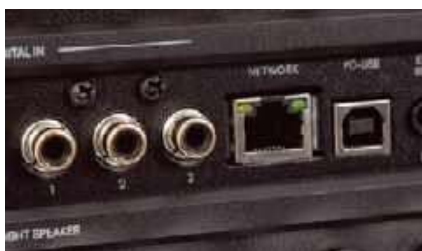
W sekcji cyfrowej najwartościowsze jest wejście USB z funkcją USB-DAC; gniazdo sieciowe LAN służy tylko do sterowania.
