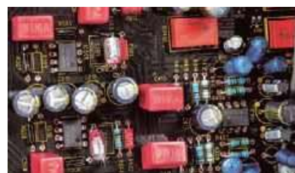
Układ przedwzmacniacza gramofonowego oparto na popularnych układach scalonych NE5532 (Texas Instruments).
