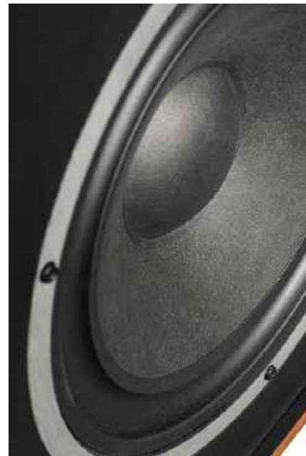
Zgodnie z założeniami obudowy typu „acoustic suspension”, zawieszenia sa- mego głośnika powinny mieć bardzo dużą podatność, co jednak trudno ocenić na oko, zwłaszcza że większy wpływ ma dolne zawieszenie.
