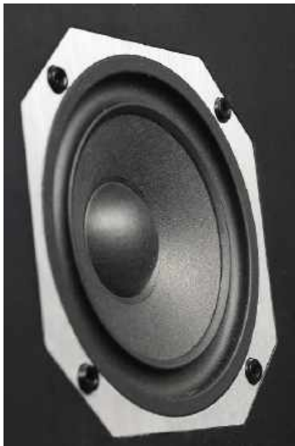
Mały, ale mocny, 12-cm przetwor- nikowy pracuje od ok. 400 Hz do ok. 3 kHz. Częstotliwości podziału są więc wyznaczone zgodnie z aktualnymi trendami. Dawniej były zwykle wyższe. Membrana średniotonowe- go, tak jak niskotonowego, jest celulozowa.
