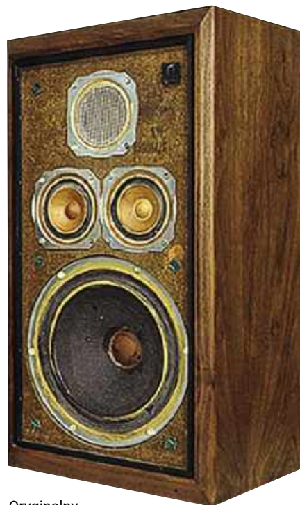
Oryginalny Model Five z 1968 roku. W swoim czasie bestseller, ale dzisiaj nie jest już wzorem do ślepego naśladowania. Wie to również konstruktor nowej wersji. Membrany były mieszkanką włókien drzewnych, wełny, bawełny i dodatków bitumicznych.
