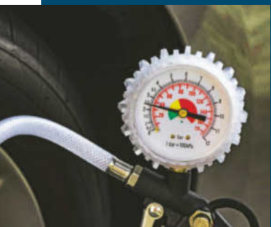
Stopień napompowania opon sprawdzaliśmy manometrem.
