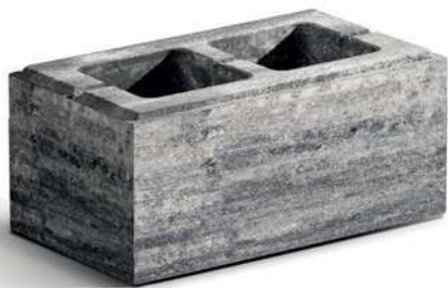
🔧 Pustaki ogrodzeniowe szalunkowe układa się warstwami i zalewa od góry betonem. FORBET
