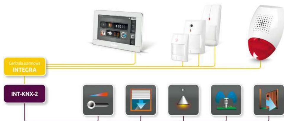
🔗 Schemat działania instalacji alarmowej. SATEL
