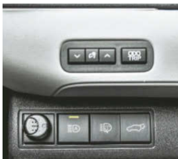
Manualna regulacja intensywności podświetlenia – najlepsze, dziś rzadkie rozwiązanie. Niżej: reflektory wyposażono w spryskiwacze.
