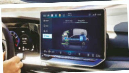
Na ekranie systemu multimedialnego można śledzić przepływ energii w napędzie HEV.
