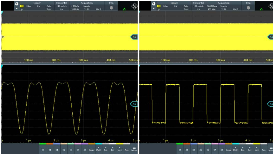
Rysunek 1. Głęboka pamięć: jedno uchwycenie obejmuje długie okno czasu i pozwala po fakcie wejść w dowolny szczegół sygnału bez ponownego pomiaru
