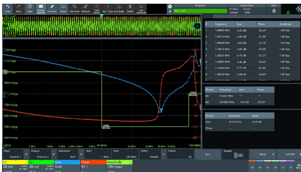
Rysunek 6. Charakterystyka Bodego: wzmacnienie i faza w funkcji częstotliwości – podstawa oceny stabilności i doboru kompensacji
