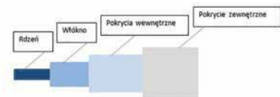
Rys. 2. Struktura prostego światłowodu.
