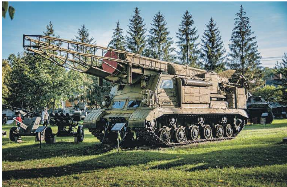
Wyrzutnia rakiet R-11M model 2P19 SCUD-A na podwoziu ISU-152
