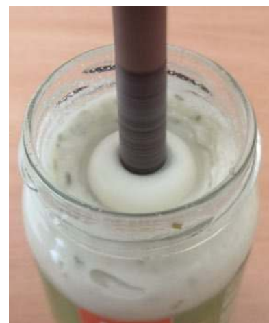
Fot. 7. Wzniesienie cieczy nienewtonowskiej (sos tartarski) spowodowane ruchem obrotowym.
