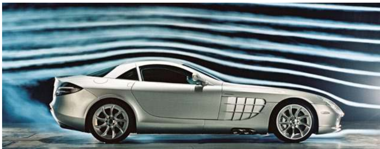
Rys. 1. Zagęszczenie strug występujące przy opływie ciała stałego.
