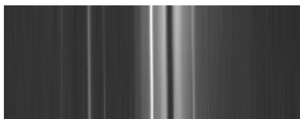
Rys. 6. Widmo ulicznej lampy sodowej uzyskane przy wykorzystaniu kamery Hyper-Cam178M, obiektywu Canon 18-55 mm oraz siatki dyfrakcyjnej 500 linii/mm. W widmie widać silne linie emisyjne sodu oraz ciemną linię absorpcyjną.
