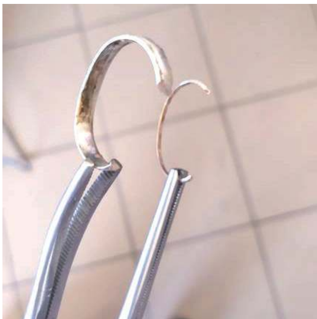
Do przecięcia obrączki strażacy użyli urządzenia typu DREMEL. Jednocześnie cały czas schładzali miejsce cięcia oraz spuchnięty palec
