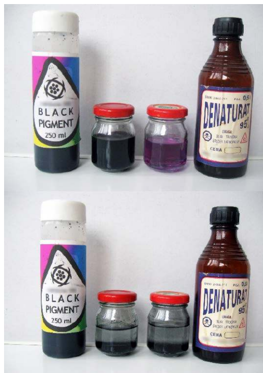
4. Adsorpcja tuszu do drukarki oraz barwnika denaturatu przez węgiel aktywny – początek i koniec eksperymentu
