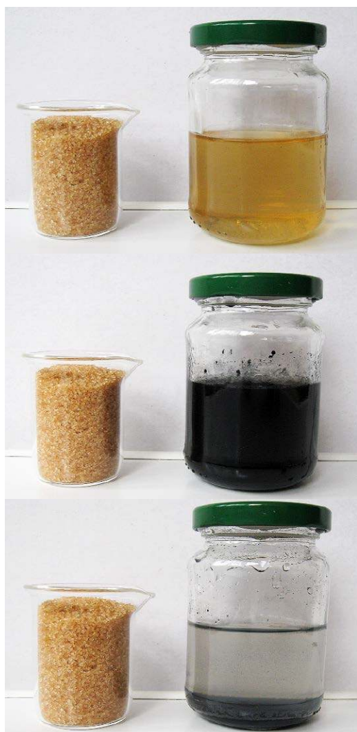
6. Adsorpcja melasy z brązowego cukru (od góry): roztwór cukru, roztwór po wysypaniu węgla, odbarwiony roztwór po zakończeniu doświadczenia
