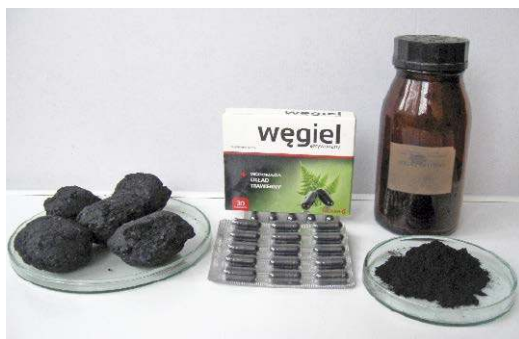
3. Źródła węgla do doświadczeń (od lewej): brykiety paliwa do grilla, węgiel medyczny, węgiel aktywny
