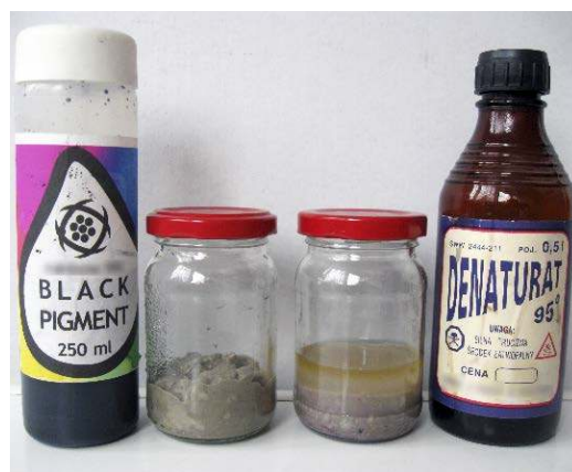
7. Adsorpcja z udziałem zeolitu: wodny roztwór tuszu został całkowicie pochłonięty, ale w przypadku denaturatu zeolit pochłoniął tylko wodę z barwnikiem
