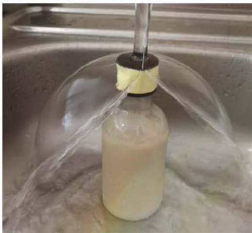
7. Model domku utworzonego z wody w wyniku jej odskoku hydraulicznego i rozptyłu na zakrętce plastikowej butelki od szamponu z ogranicznikiem wykonanym z kawałka drutu (fragment spinaacza biurowego), przymocowanym taśmą klejącą do brzegu zakrętki
