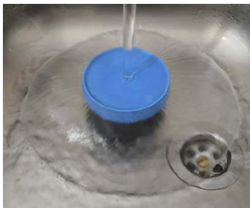
3. Odskok hydrauliczny i rozptyw wody na pokrywie pudetka od pasty do czyszczenia naczyń
