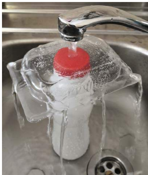
4. Skutek użycia do doświadczenia przedmiotu o zbyt dużej powierzchni – plastikowej tacki od produktów spożywczych
