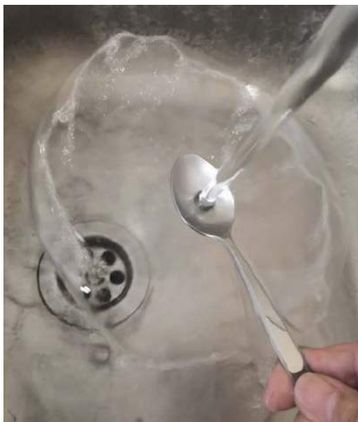
6. Na powierzchni łyżeczki też można zademonstrować efektowny odskok hydrauliczny, tym razem zachodzący wraz z rzutem ukośnym
