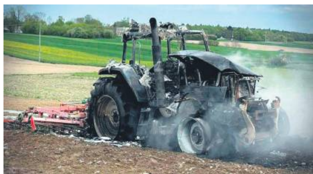
Prawdopodobną przyczyną pożaru ciągnika marki Case było zwarcie instalacji elektrycznej w maszynie. Fot. OSP w Trzuszczanach
