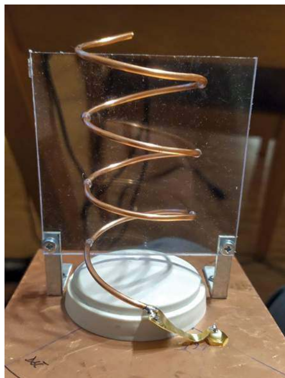
Antena helikalna na 2,4 GHz z zamontowanym konwerterem satelitarным w reflektorze
