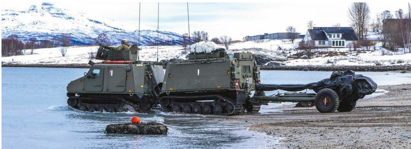
▲ Możliwości BvS 10 na przykładzie holowania lekkiej haubicy kal. 105 mm brytyjskiej rodziny LightGun.
