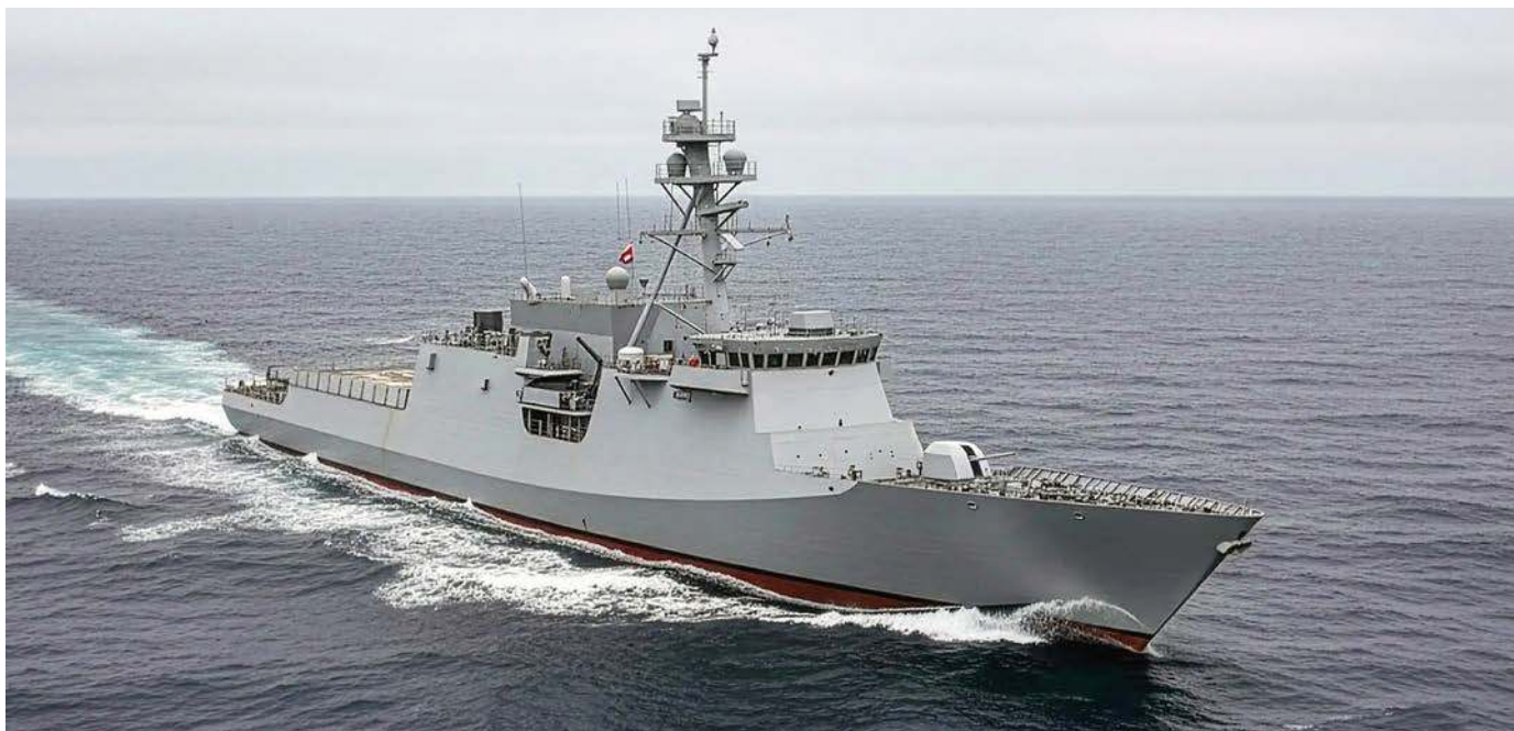
▲ Panaceum na skasowanie programu FFG(X) mają być „budżetowe” fregaty rakietowe lekkie (FFX), bazujące swoją konstrukcją na kadłubie dużych okrętów patrolowych typu Legend , zaprojektowanych na potrzeby US Coast Guard.
