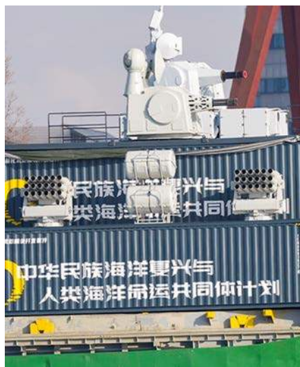
▲ Para armat rotacyjnych na dziobie Zhong Da . Na pierwszym planie okrętowy kompleks H/PJ-11.
