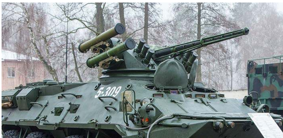
▲ Moduł bojowy BM-3M Szturm-M z ppk Barier osadzony na transporterze opancerzonym BTR-3E1 z Gwardii Narodowej Ukrainy.
