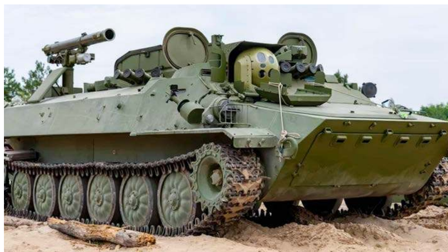
▲ Samobieżny zestaw przeciwpancerny Szturm-SM , a w jego przedniej części kadłuba widoczna zainstalowana optoelektroniczna stacja celownicza OPSN-I.
