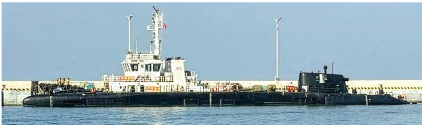
▲ Podwodny trimaran z nadbudówką przypominającą kiosk z okrętu podwodnego.
