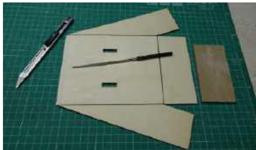
Elementy rampy warto przeszlifować i odpowiednio sfazować
