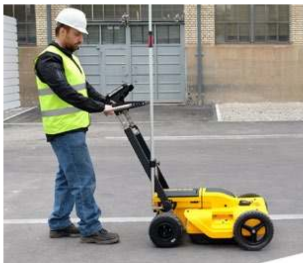
Fot. 8. Radar geodezyjny w czasie pracy.
