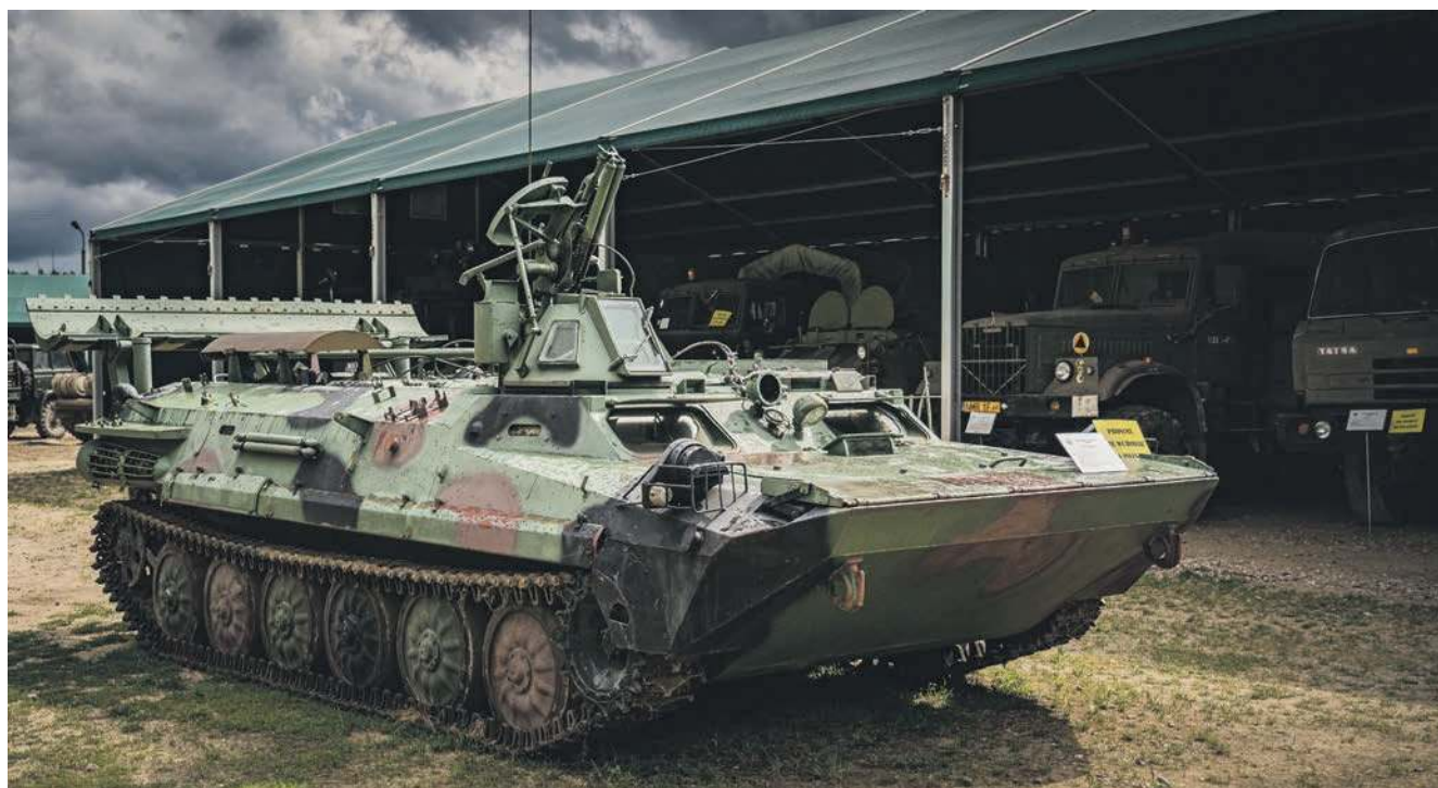
Wóz pogotowia technicznego WPT Mors przeznaczony do ewakuacji z pola walki pojazdów o masie do 14 ton
