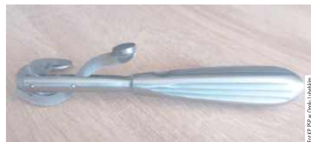
Narzędzie wyglądem przypomina nożyczki i jest wykorzystywane przez strażaków tylko do cięcia biżuterii
